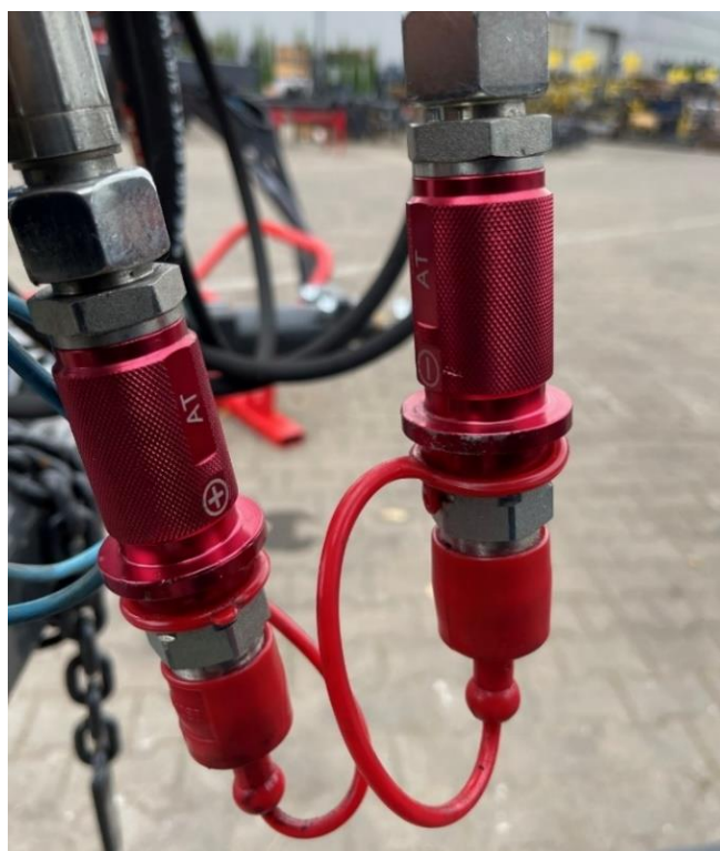
Rysunek 37. Oznaczenie kierunku przepływu oleju w przewodach hydraulicznych
