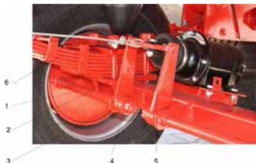
Abb.6. Elemente der Bremsanlage
