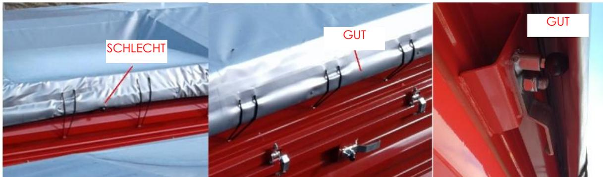
**Abbildung 3.** Richtige Spannung der Plane
