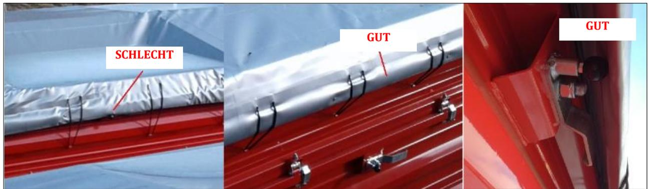
**Abbildung 3.** Richtige Spannung der Plane
