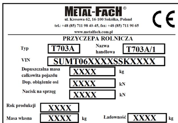
Rysunek 3. Przykładowa tabliczka znamionowa przyczepy zgodna z CE
