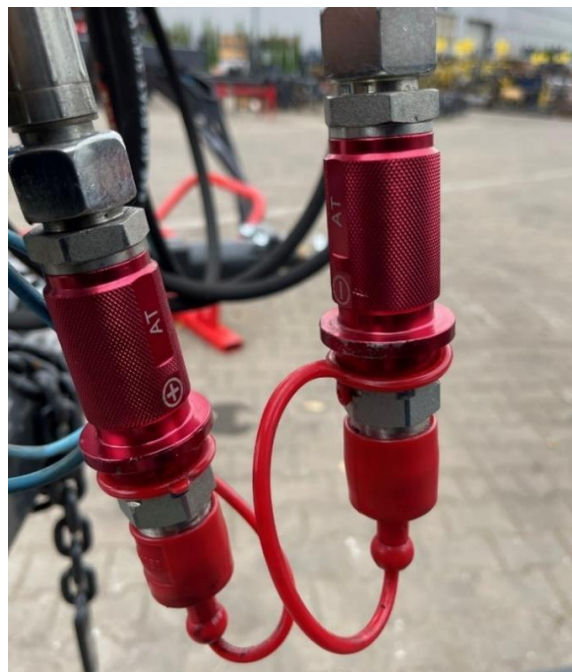
Figure 39. Désignation du sens de flux de l'huile dans les conduites hydrauliques
