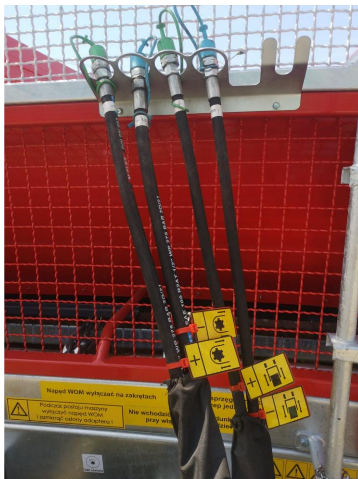
Rysunek 16. Oznaczenie złączy przewodów hydraulicznych piktogramami ułatwiającymi podłączenie przewodu do ciągnika (standard)
