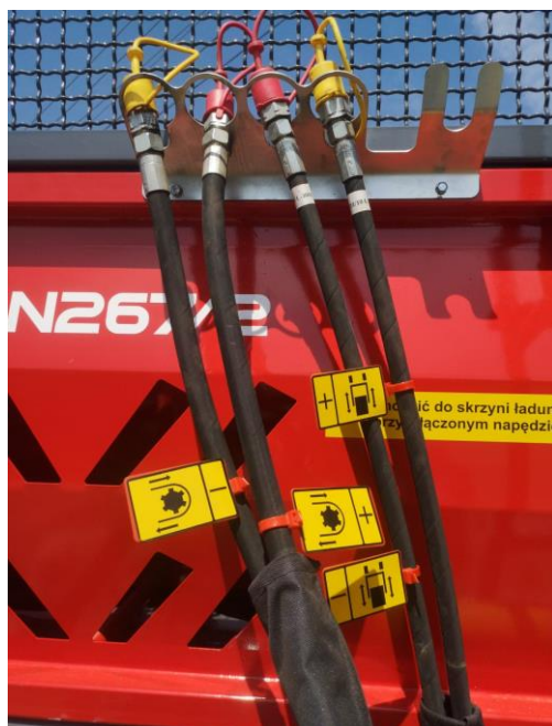
Rysunek 21. Oznaczenie złączy przewodów hydraulicznych piktogramami ułatwiającymi podłączenie przewodu do ciągnika (standard)
