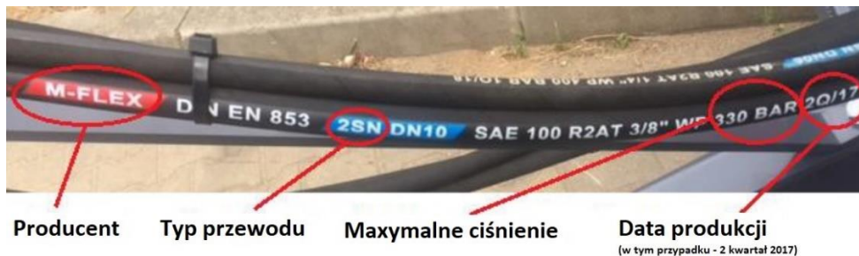
Rysunek 20. Oznaczenie przewodów hydraulicznych
