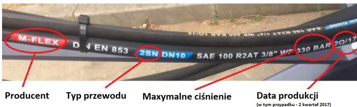
Rysunek 35. Oznaczenie przewodów hydraulicznych
