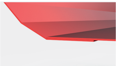
Skrzynia przyczepy - podłoga wykonana z blachy grubości 8mm, ściany boczne wykonane z blachą grubości 6mm
