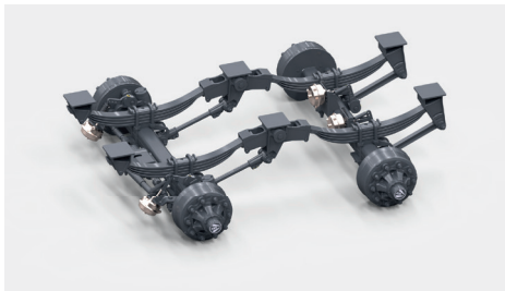
Zawieszenie Tandem z resorem 4 piórowym
