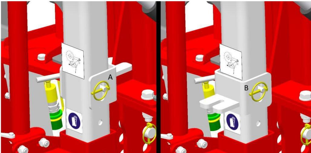
**Figura 46.** Bloqueo de transporte del brazo de encintado: A - posición bloqueada; B - posición desbloqueada
