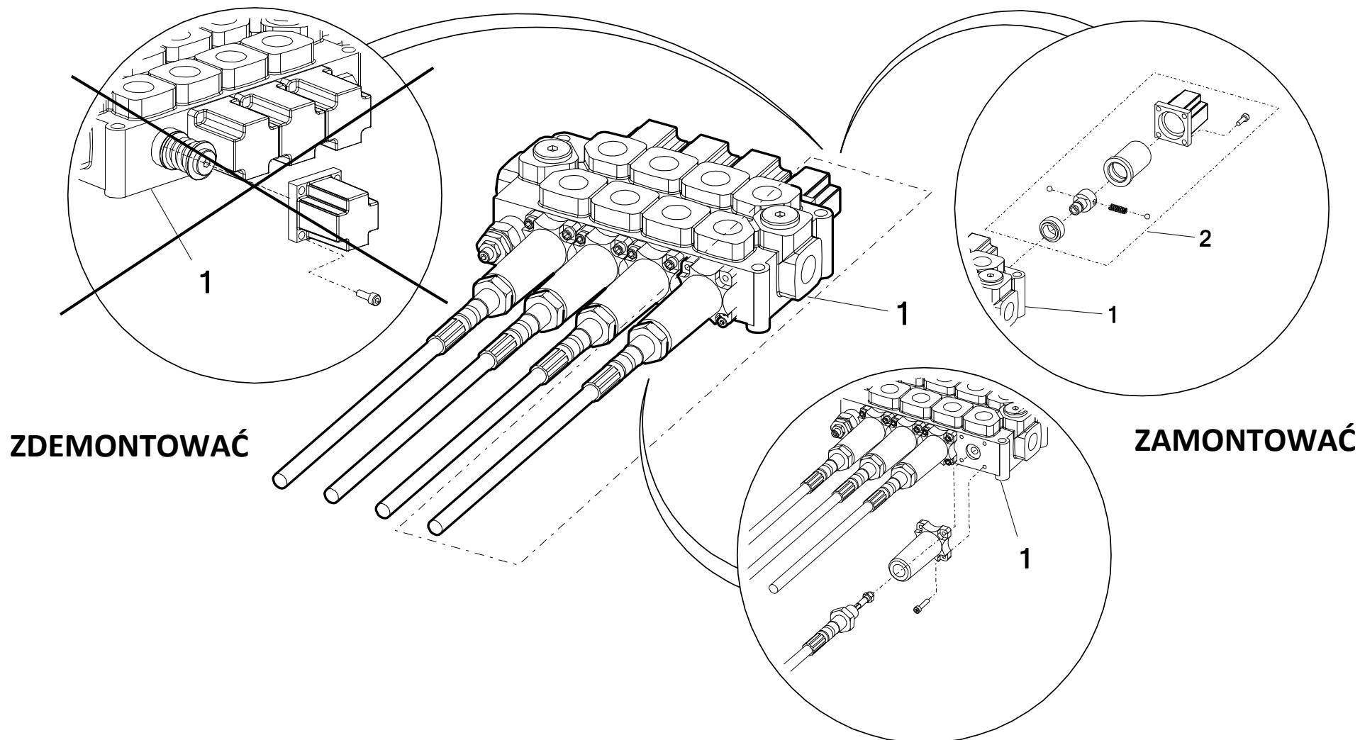
**72. UKŁAD HYDRAULIKI CZTEROSEKCYJNEJ Z ROZDZIELACZEM – sekcja rozdzielacza**
