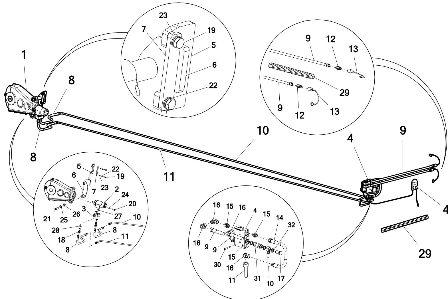
**63. UKŁAD HYDRAULIKI CZTEROSEKCYJNEJ – sekcja przenośnika podłogowego
