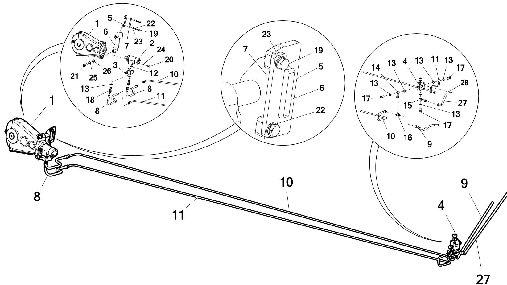
**69. UKŁAD HYDRAULIKI CZTEROSEKCYJNEJ Z ROZDZIELACZEM – sekcja
