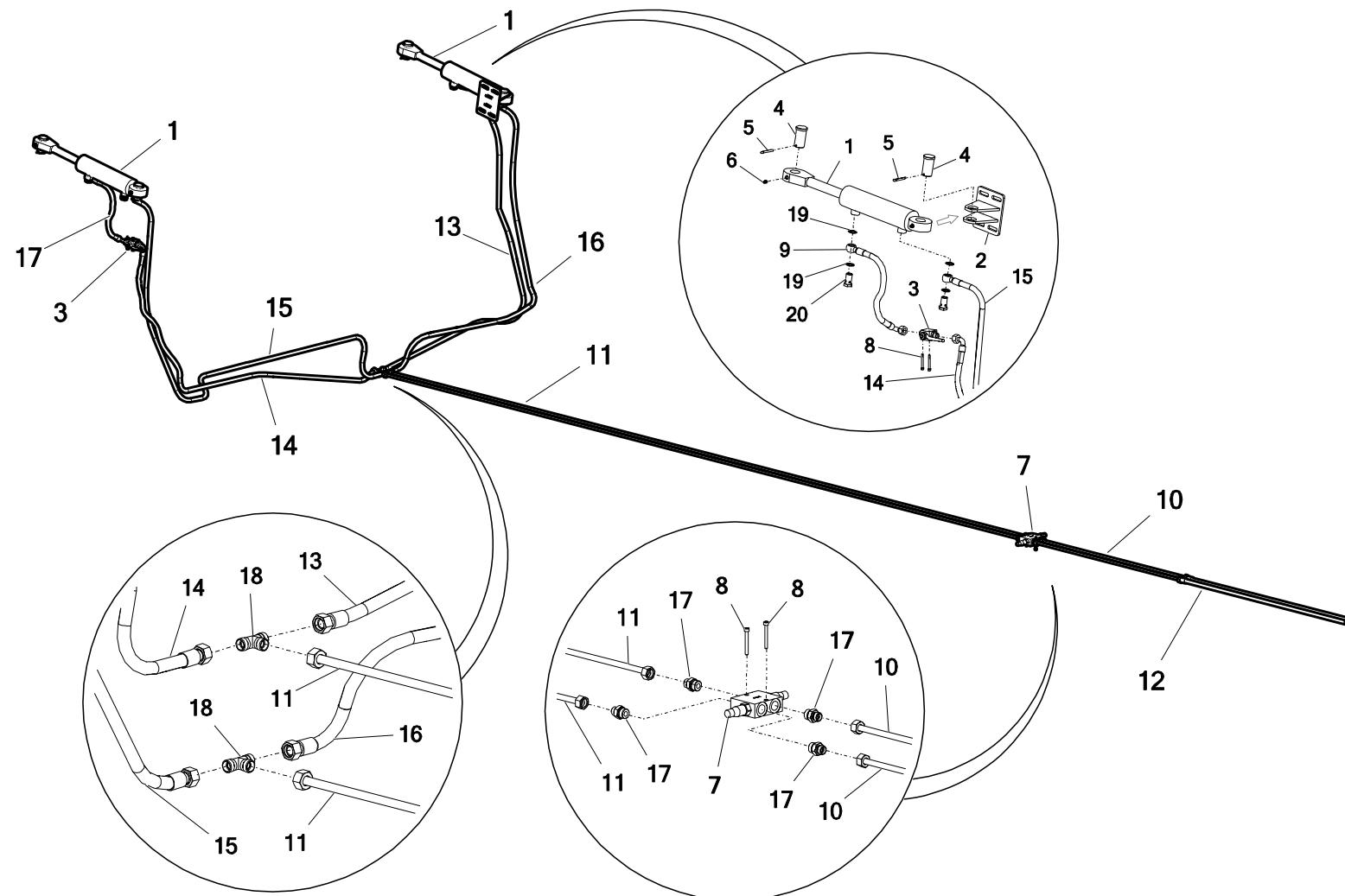
**66. UKŁAD HYDRAULIKI CZTEROSEKCYJNEJ Z ROZDZIELACZEM – sekcja osłony adaptera pionowego**
