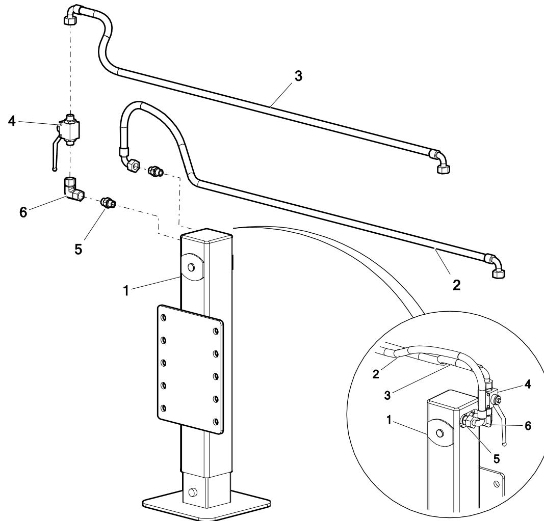
**70. UKŁAD HYDRAULIKI CZTEROSEKCYJNEJ Z ROZDZIELACZEM – sekcja stopki podporowej**
