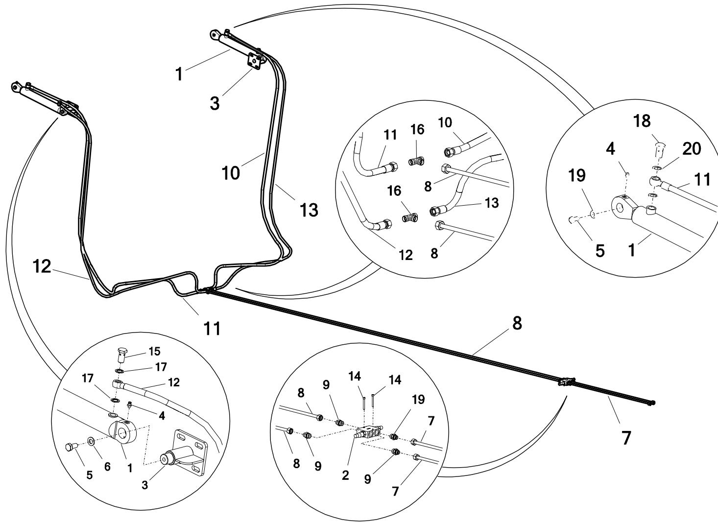
**67. UKŁAD HYDRAULIKI CZTEROSEKCYJNEJ Z ROZDZIELACZEM – sekcja osłony adaptera poziomego**
