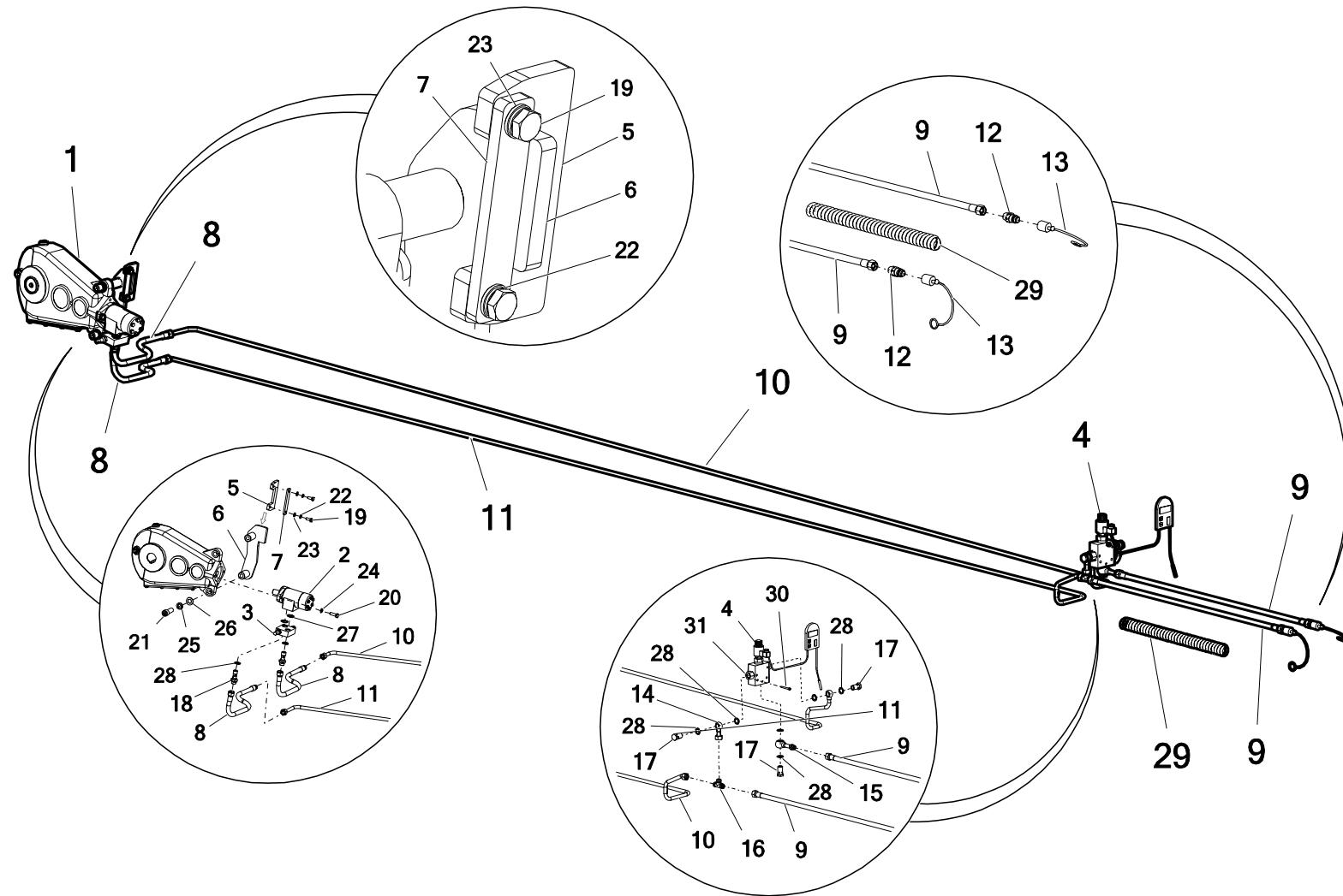
**62. UKŁAD HYDRAULIKI CZTEROSEKCYJNEJ – sekcja przenośnika podłogowego
