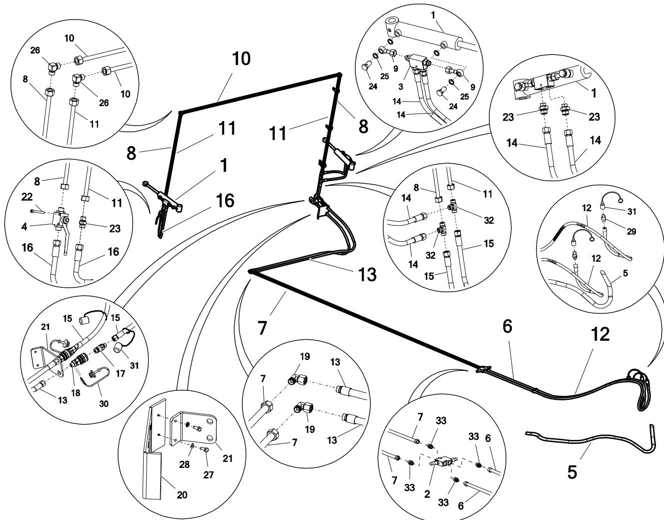
**57. UKŁAD HYDRAULIKI CZTEROSEKCYJNEJ – sekcja osłony adaptera pionowego (od 2022 roku)**
