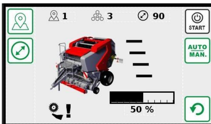
Figura 30. Panel de control: pantalla de funcionamiento
