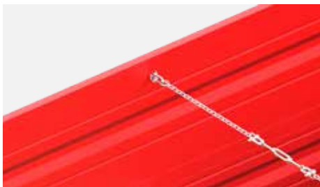
Łańcuch spinający - usztywnia ściany przestrzeni ładunkowej
