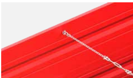
Łańcuch spinający - usztywnia ścianę przestrzeni ładunkowej
