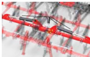
U487 NOVALIS TRIO 420 - rama składana hydraulicznie
