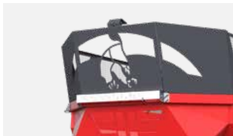
Wskaźnik położenia zasuwy – umożliwia precyzyjną kontrolę nad ustawieniem zasuwy, co zwiększa efektywność pracy
