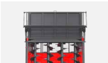
Ostona unoszona automatycznie przy podniesieniu ściany tylnej (zasuwy) (verti X4)
