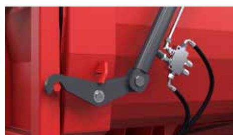
Tylne kłapy otwierane hydraulicznie - standardowo zamki hydrauliczne kłapy tylnej
