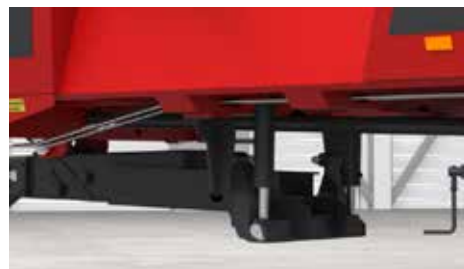
Dyszel amortyzowany hydraulicznie
