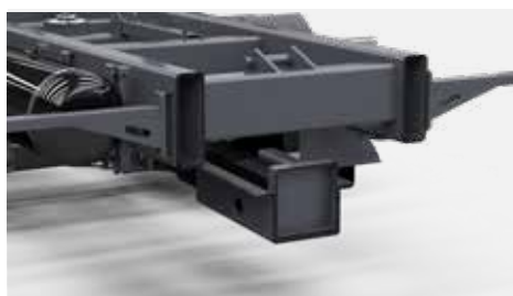
Konstrukcja ramy nosnej wykonana z rury prostokątnej grubościenniej
