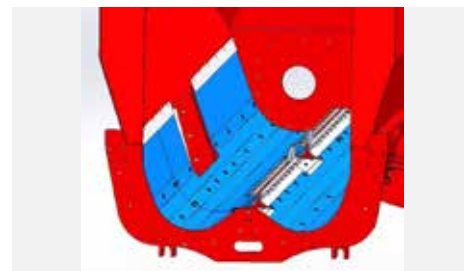
Zabezpieczenie dna - tworzywem sztucznym, które charakteryzuje się wysoką odpornością na ścieranie oraz zabezpiecza stalowe dno przed wycieraniem i korozją
