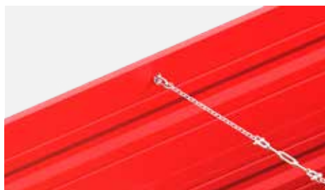
Łańcuch spinający – usztywnia ściany przestrzeni ładunkowej
