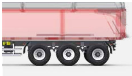
Zawieszenie 3 osiowe - TRIDEM z resorem 4 piórowym
