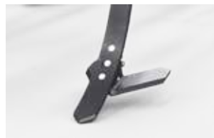
Zqb typu Horsh z lemieszami bocznymi - uprawa do 15 cm
