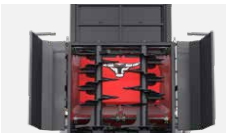
Hydraulicznie podnoszona zasuwa gilotynowa, w dolnej części uszczelniona pasem gumowym
