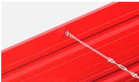
Łańcuch spinający - usztywnia ściany przestrzeni ładunkowej
