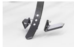
Zdjęcie lemieszy bocznych umożliwia pracę na głębokość do 30 cm
