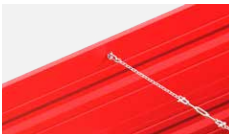
Łańcuch spinający - usztywnia ścianę przestrzeni ładunkowej
