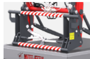
Mocowanie osprzętu – ramka EURO
