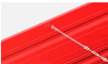
Łańcuch spinający - usztywnia ściany przestrzeni ładunkowej
