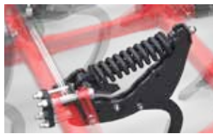
Zabezpieczenie sprężynowe - przeciążeniowe elementów roboczych
