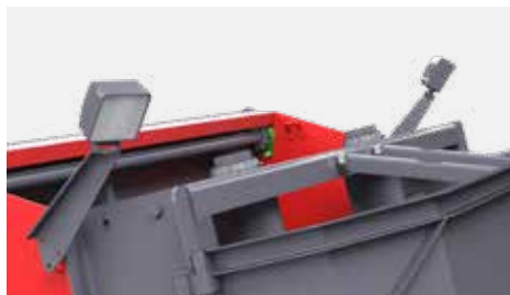
Oświetlenie robocze do pracy po zmroku –szperacze
