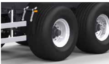
Standardowo opony 560/60-R22,5 (RADIALNE -konstrukcja opony wzmocniona)
