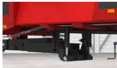
Dyszel amortyzowany hydraulicznie – redukuje drgania, poprawiając komfort jazdy i zwiększając bezpieczeństwo
