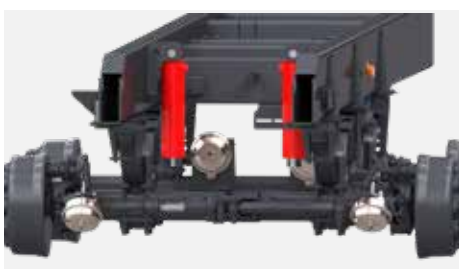
Stabilizacja hydrauliczna osi
