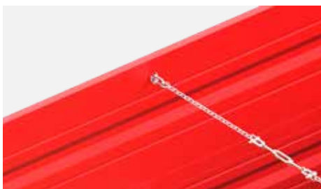
Łańcuch spinający - usztywnia ściany przestrzeni ładunkowej
