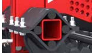
Amortyzatory gumowe zapobiegają możliwości trwałego odkształcenia ramienia STRENX
