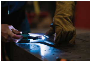
Zakres spawania wg. WPQR od 0,5mm do 4mm (TIG)
