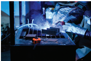
Zakres spawania wg. WPQR od 0.5 do 40mm (MIG MAG)
