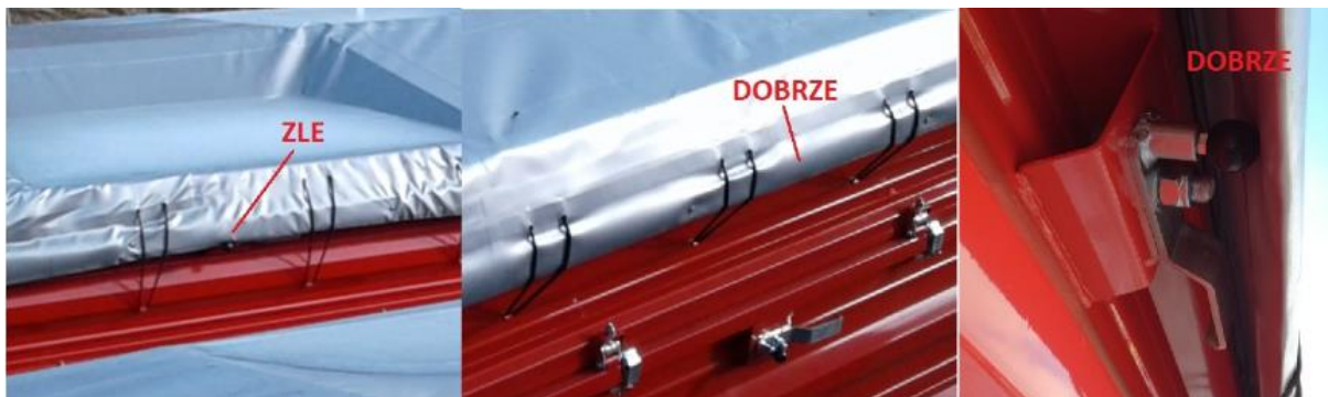
Rysunek 3. Prawidłowy naciąg plandeki
