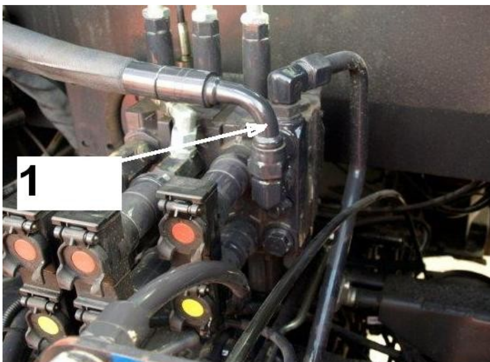
Rys. 2. Miejsce rozpięcia instalacji ciągnika i podłączenia zasilania rozdzielacza ładowacza
