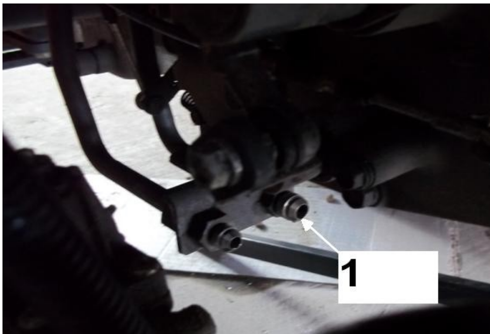
Rys. 2. Miejsce rozpięcia instalacji ciągnika i podłączenia zasilania rozdzielacza ładowacza
