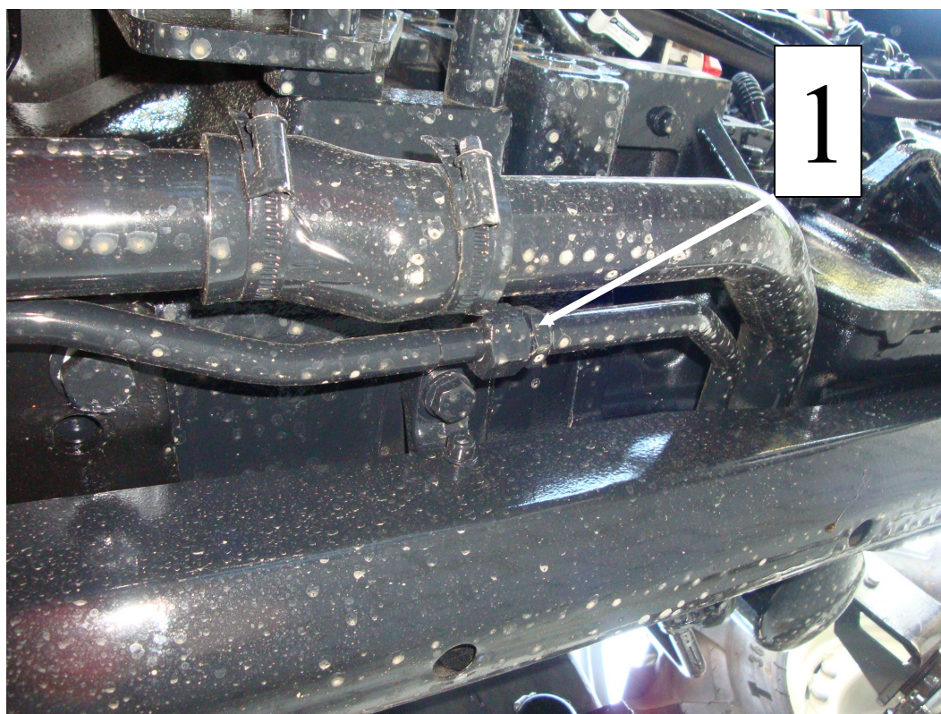
Rys. 2. Miejsce rozpięcia instalacji ciągnika i podłączenia zasilania rozdzielacza ładowacza ( widok z dołu ciągnika, prawa strona, na wysokości skrzyni biegów)
