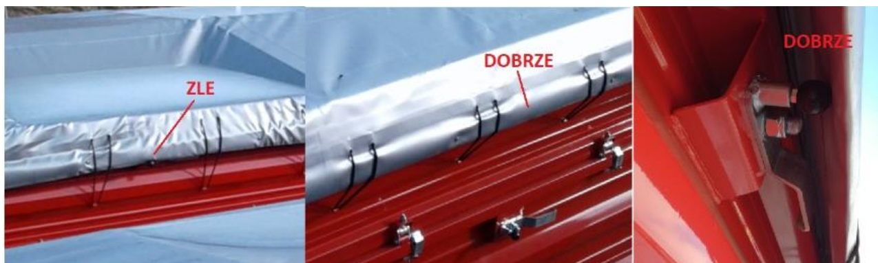
Rysunek 3. Prawidłowy naciąg plandeki
