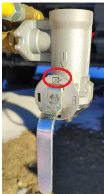
Rysunek 20. Regulator siły hamowania 4-zakresowy
