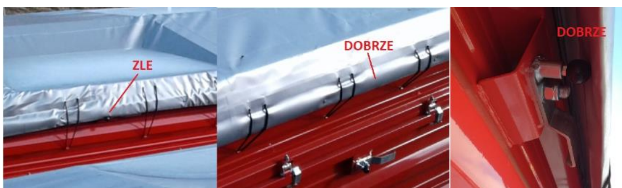
Rysunek 3. Prawidłowy naciąg plandeki
