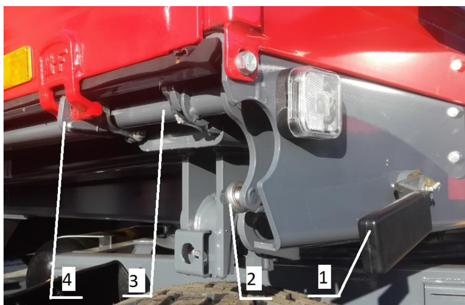
Rysunek 33. Zamki ścian skrzyni ładunkowej: 1- dźwignia centralna zamków dolnych, 2- mechanizm regulacji zamków, 3- centralny wałek zamków, 4-zamek
