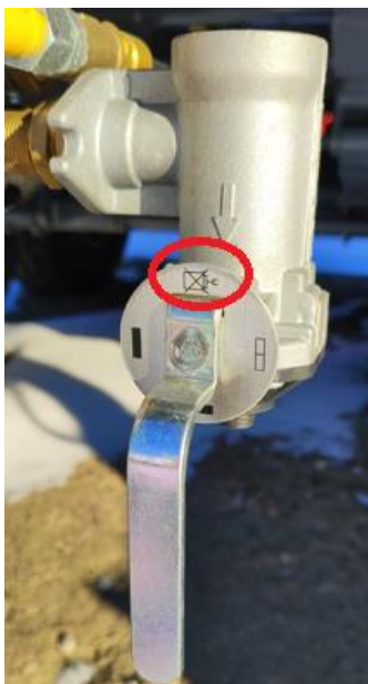
Rysunek 20. Regulator siły hamowania 4-zakresowy
