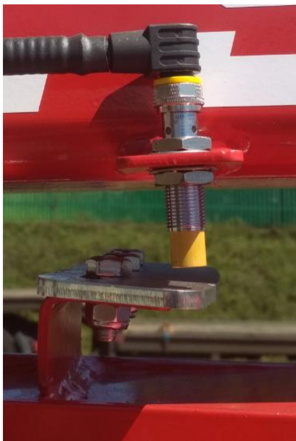
Rysunek 22. Ustawienie indukcyjnego czujnika obrotów
