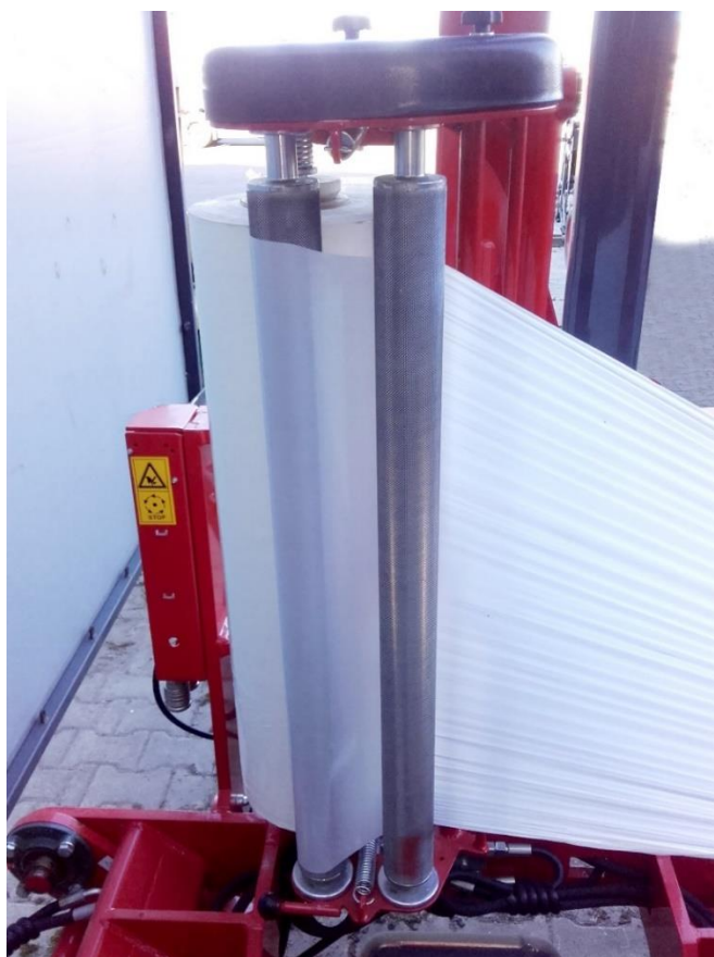
Rysunek 35. Prawidłowe założenie folii w podajniku
