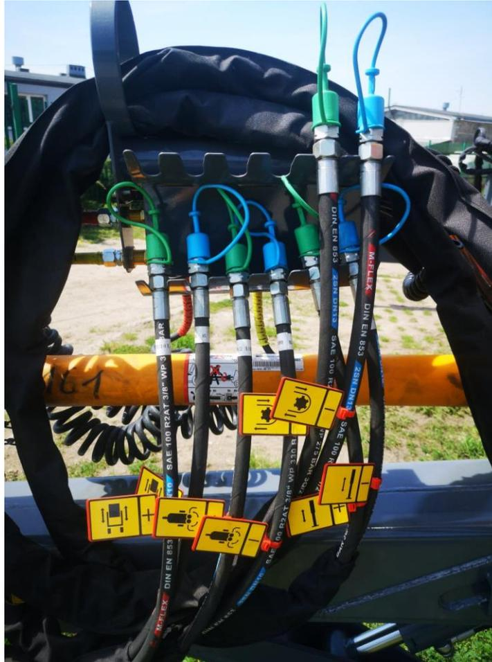
**Figure 22.** Pictogrammes sur les raccords des conduites hydrauliques pour faciliter la connexion au tracteur (standard)
