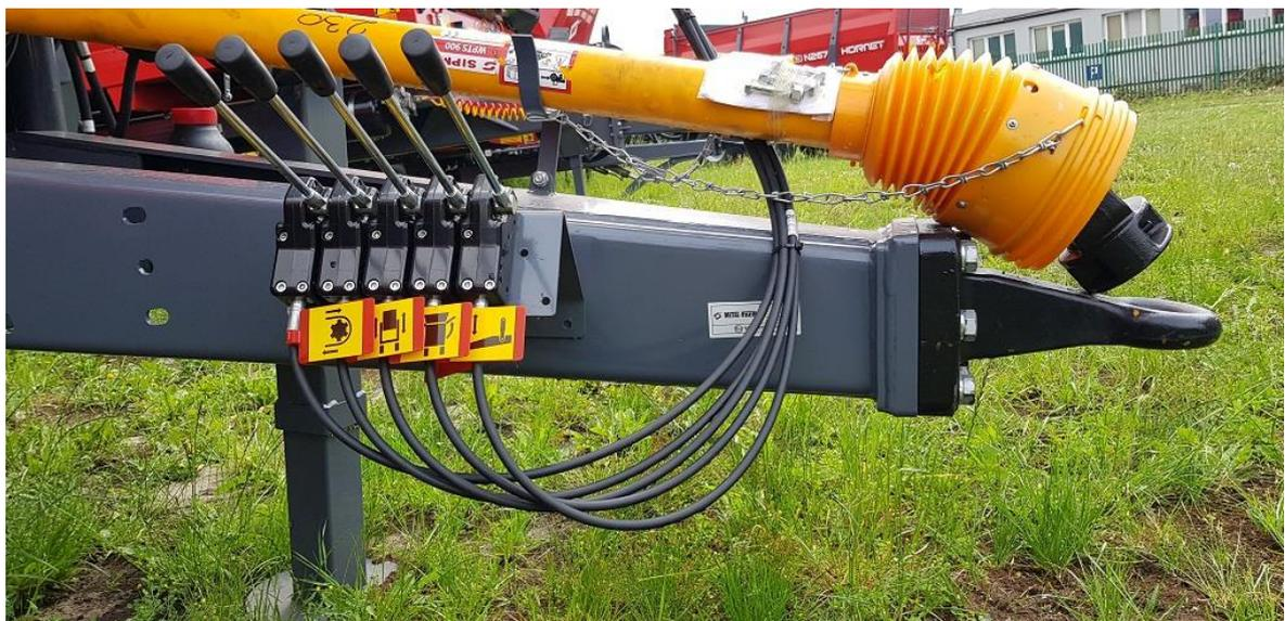
**Figure 23.** Marquage par pictogramme des leviers de commande du répartiteur (la commande du répartiteur est disponible en option).
