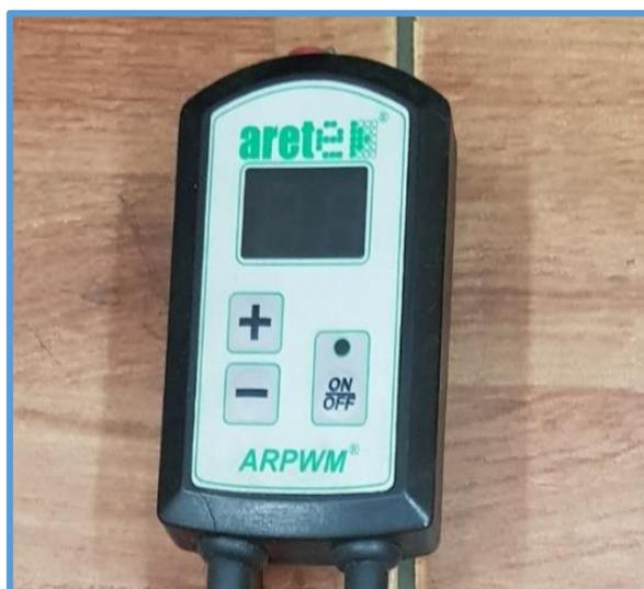
**Figure 25.** Panneau de commande pour le réglage de la vitesse du fond mouvant avec boutons « +/- » (équipement en option).
