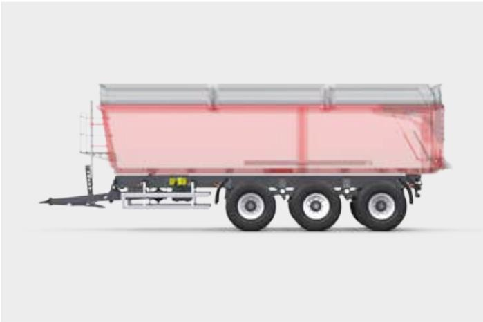
Tridem-Aufhängung mit erster und dritter Schlepplenkachse - starre Mittelachse.
