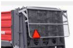
Automatisch beim 'Anheben der Hinterwand (Schieber) gehobene Adapterabdeckung
