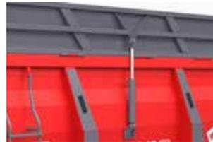
Möglichkeit den hydraulischen Aufsatz zu senken und zu heben. Die Steuerung wird aus der Schlepperkabine realisiert
