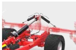
Hydraulische Arbeitseinstellung über U910 Träger
