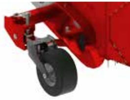
Fahrräder - Ermöglichen eine Höhenverstellung sowie ein "lockere Drehung".
