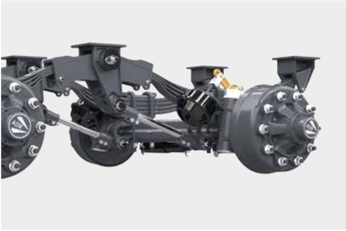
TANDEM Blattfederung - passive Lenkachse - Nachlauflenker
