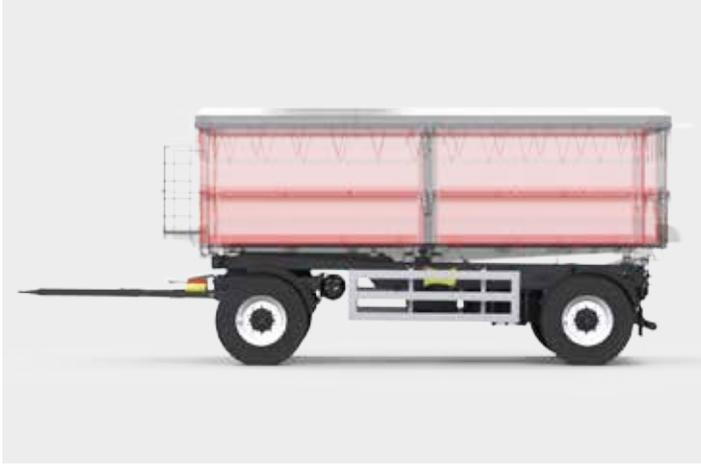
Es wird ein zweiachsiges Fahrgestell eingesetzt, dadurch werden keine zusätzlichen Lasten auf den Schlepper übertragen
