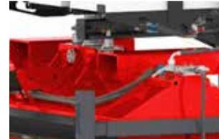
Gabelaufsatz - Ermöglicht ein schnelles Ankuppeln der Kehrmaschine. Standardausrüstung der Maschine. Fester Kehrmaschinenbetrieb.
