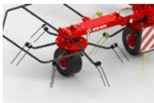
Wenderzinken - aus Draht mit 10 mm Durchmesser.
