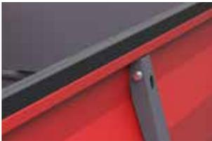
Bordwände mit Gummileisten gegen Beschädigungen geschützt
