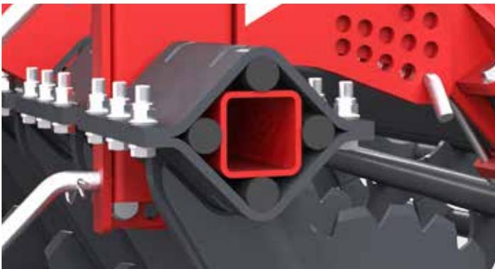
Gummistoßdämpfer verhindern eine dauerhafte Verformung des STRENX-Arms
