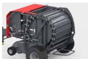
**Kettenkammer** - Die Pressdichte kann vom Benutzer stufenlos nach seinen eigenen Bedürfnissen eingestellt werden.
