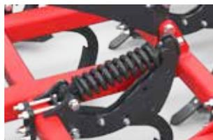
Schrauben-Überlastschutz der Arbeitselemente
