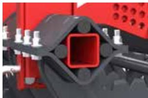
Gummistoßdämpfer verhindern eine dauerhafte Verformung des STRENX-Arms
