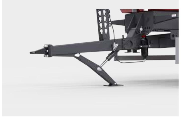
Hydraulisch gesteuerte Scherenstütze
