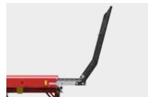
Bei der neuen Ballenplattform wurde die Verlängerung von 800 mm auf 1.000 mm erhöht.
