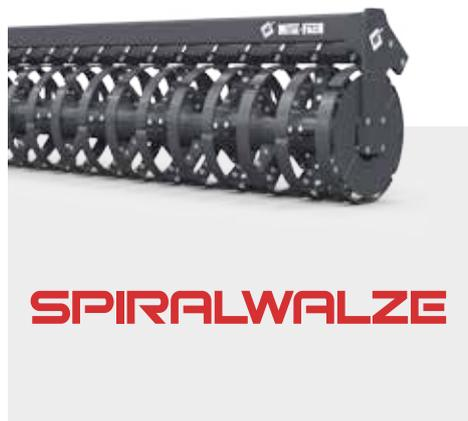
Ihre Konstruktion verhindert, dass der Boden an der Walze haften bleibt. Zwischen den Federringen der Walze befinden sich Elemente der Schleppe. Diese Walze wird zur tieferen Bodenverdichtung und gleichzeitig zur Lockerung der Oberflächenschicht eingesetzt. Die Elastizität der Federn sorgt dafür, dass der Boden über die gesamte Arbeitsbreite gleichmäßig verdichtet wird und die Walze selbstreinigend ist.
