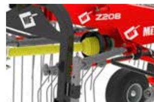
Steuertrume - Zugtrume, die stufenlose Drehung der Kupplung um bis zu 20° nach links oder rechts ermöglichen.
