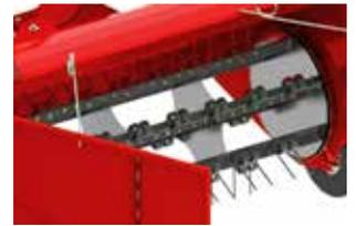
Zinkenfedern - sind mit Sicherheitsvorrichtungen versehen, die verhindern, dass gebrochene oder beschädigte Federn in die Schwaden gelangen.
