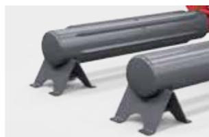
Trommelstützen - sorgen für stabiles und sicheres Abstellen des vom Schlepper abgekoppelten Wicklers
