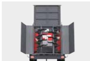
Hydraulisch angehobene Rückwand, im unteren Teil mit Gummiband abgedichtet
