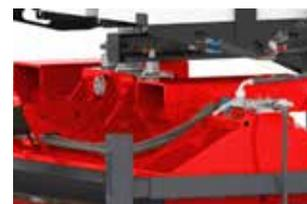
Fijación de horquilla: permite un acoplamiento rápido de la barredora. Equipamiento estándar de la máquina. Operación de la barredora en opción rígida.
