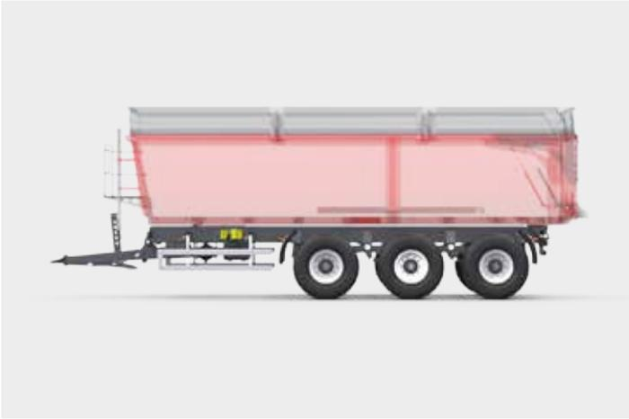
Suspensión Tridem con primer y tercer eje de torsión pasivo - eje central fijo.
