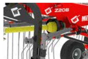
Tirantes de control - Un sistema de dos cables que permite que el funcionamiento suave de giro del enganche 20° a la izquierda o a la derecha.
