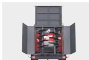
Pared trasera elevada hidráulicamente, sellada en la parte inferior con una cinta de caucho
