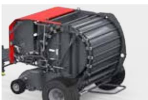
Cámara cilíndrica y de cadena: perfecta para materiales secos y húmedos.
