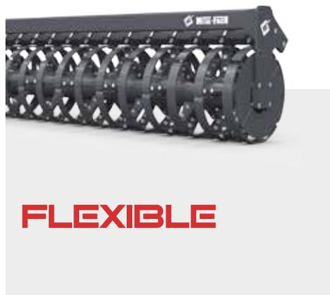
El diseño del rodillo evita que el terreno se pegue al rodillo. Entre los anillos de resorte del rodillo hay elementos de la placa niveladora. El rodillo se utiliza para una compactación más profunda del terreno y al mismo tiempo para remover la capa superficial. La elasticidad de los resortes garantiza una compactación uniforme del terreno en toda la anchura de trabajo y una autolimpieza.
