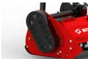
Transmisión por correa - Transmisión de potencia mediante 4 correas trapezoidales. Protección de la máquina. Sistema de embragues CLAMPEX.
