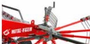
Ajuste de la altura del rastrillo - Ajuste mecánico para un posicionamiento preciso de las dientes.
