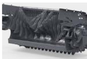
Rotor y cuchillas: la unidad de alimentación giratoria obliga a introducir el material en la cámara de empacado de manera uniforme
