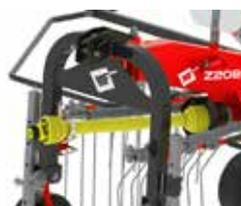
Esquina - Fabricada con perfil de sección cuadrada de 80 x 80. Diseño compacto y rígido.
