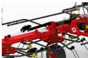
Ajuste del ángulo de trabajo - Ajuste mecánico del ángulo de trabajo para un posicionamiento preciso de las dientes.
