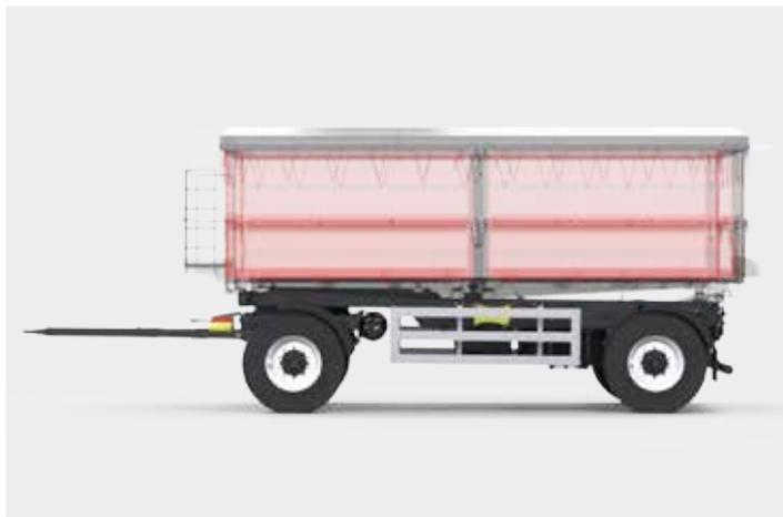
Se utiliza un chasis de dos ejes para que no se transfieran cargas adicionales al tractor
