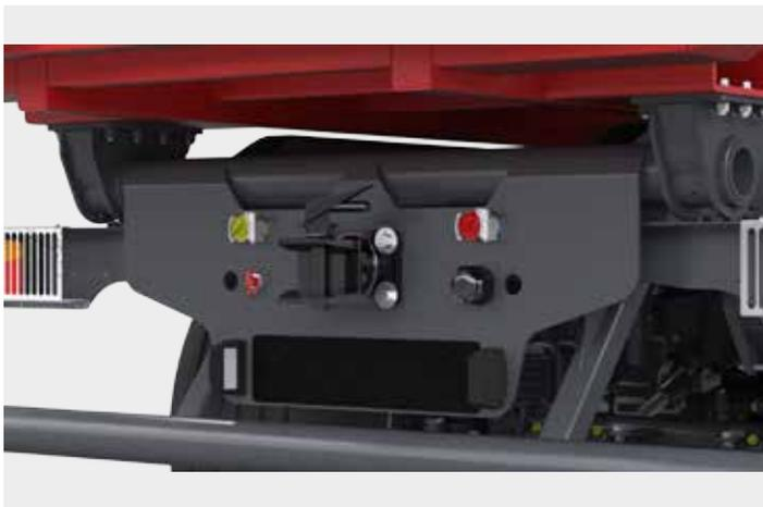
Salida de medios (conexión eléctrica, neumática e hidráulica)
