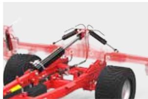
Ajuste hidráulico del trabajo a través del soporte U910
