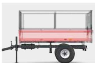
Chasis de un eje para facilitar la maniobrabilidad
