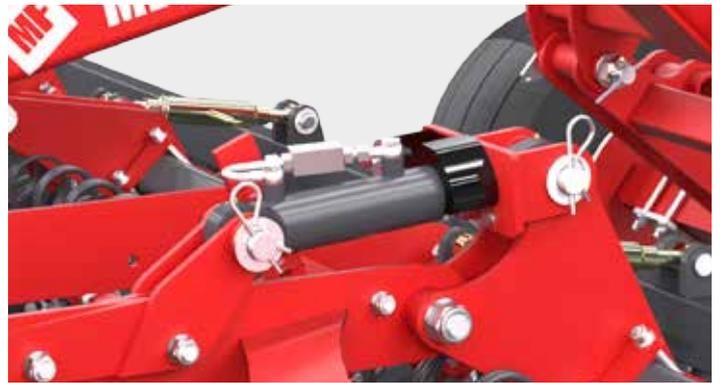
Ajuste hidráulico de la profundidad de labranza: garantiza un ajuste preciso
