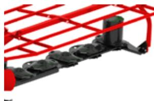
Cada disco está protegido por un punto de ruptura definido y, en caso de colisión, el disco se desconecta del sistema de accionamiento.
