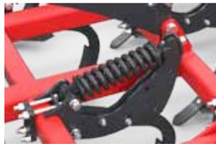
Mecanismo de seguridad de tornillo contra las sobrecargas de los elementos funcionales
