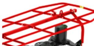
**Elevación de la parte delantera de la cubierta protectora:** facilita el acceso a la barra de corte cuando se sustituyen las cuchillas.
