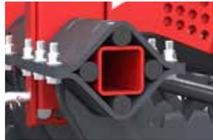
Los amortiguadores de caucho evitan la deformación permanente del brazo STRENX
