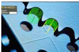
Skanowanie 3D elementów małogabarytowych - pomiar bez pliku CAD
