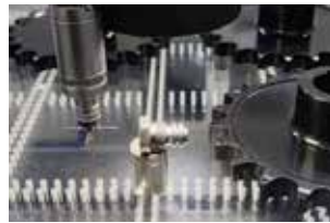
Pomiar na maszynie CMN przy użyciu sondy kątowej
