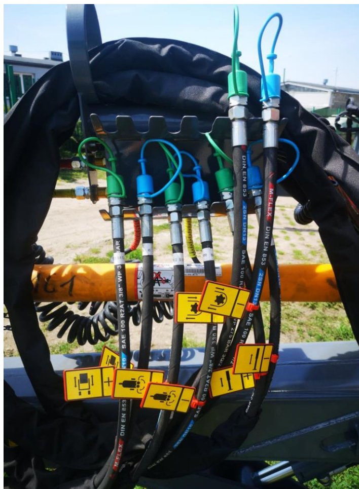
Rysunek 23. Oznaczenie złączy przewodów hydraulicznych piktogramami ułatwiającymi podłączenie przewodu do ciągnika (standard)
