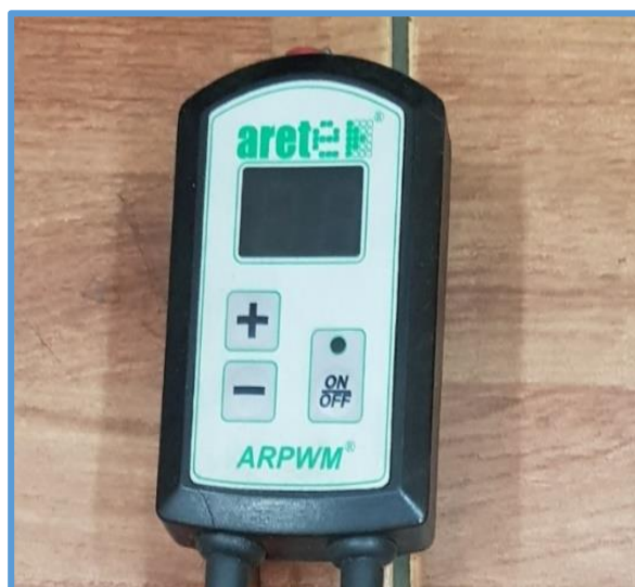
Rysunek 26. Panel sterujący regulacją prędkości przesuwu przenośnika podłogowego za pomocą przycisków „+/-”, (wyposażenie opcjonalne).
