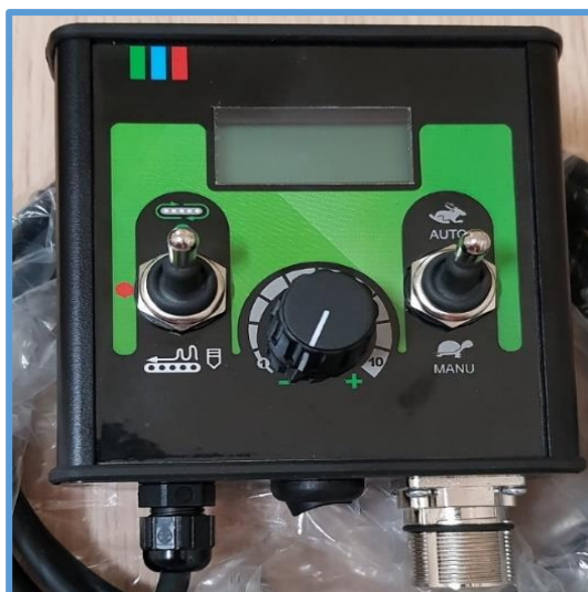
Rysunek 27. Panel sterujący regulacją prędkości przesuwu przenośnika podłogowego za pomocą potencjometru - gałki sterującej (wyposażenie opcjonalne).
