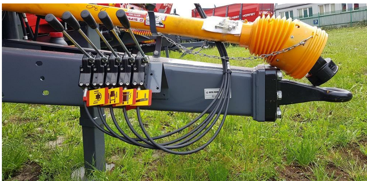
Rysunek 24. Oznaczenie piktogramami dźwigni sterujących rozdzielaczem (sterowanie rozdzielaczem występuje jako opcja)
