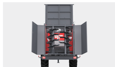
Hydraulicznie podnoszona zasuwka gilotynowa, w dolnej części uszczelniona pasem gumowym
