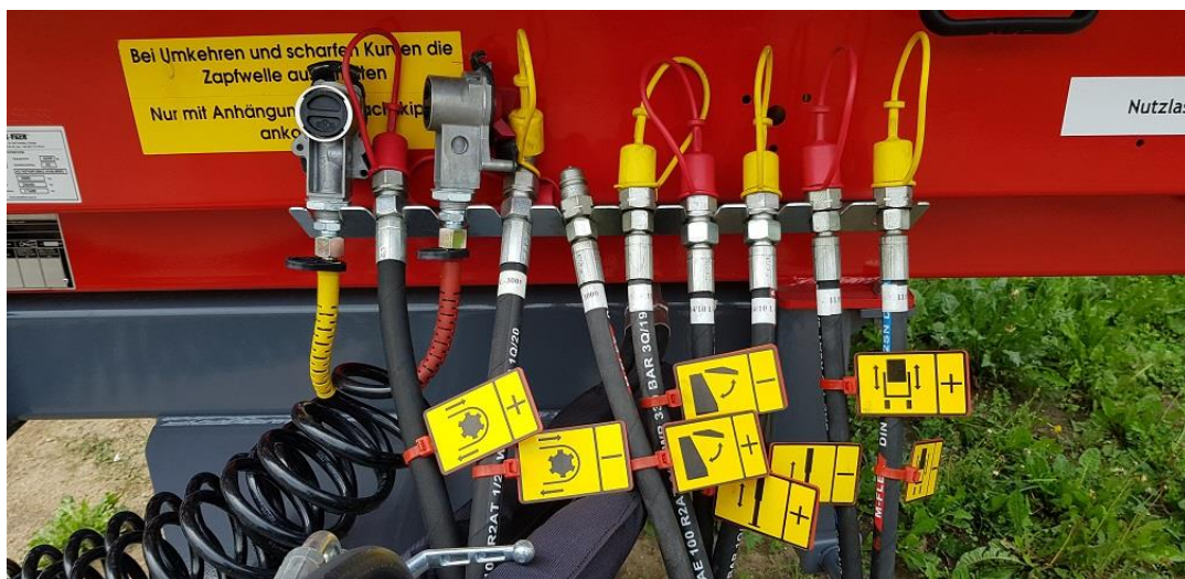
Рисунок 24. Пиктограммы на разъемах гидравлических линий для облегчения подключения линии к трактору
