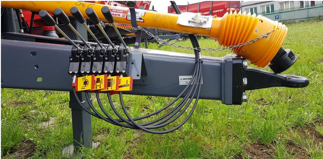
Рисунок 25. Пиктограммы, обозначающие рычаги управления распределителем (управление распределителем предлагается в качестве опции)
