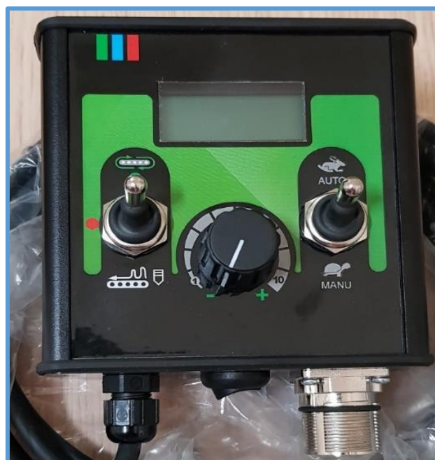
Рисунок 29. Панель управления для регулировки скорости перемещения напольного конвейера с помощью потенциометра - ручки управления (дополнительное оснащение).
