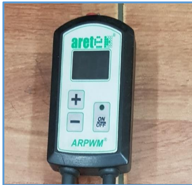
Рисунок 28. Панель управления для регулировки скорости перемещения напольного конвейера с кнопками «+/-» (дополнительное оснащение).
