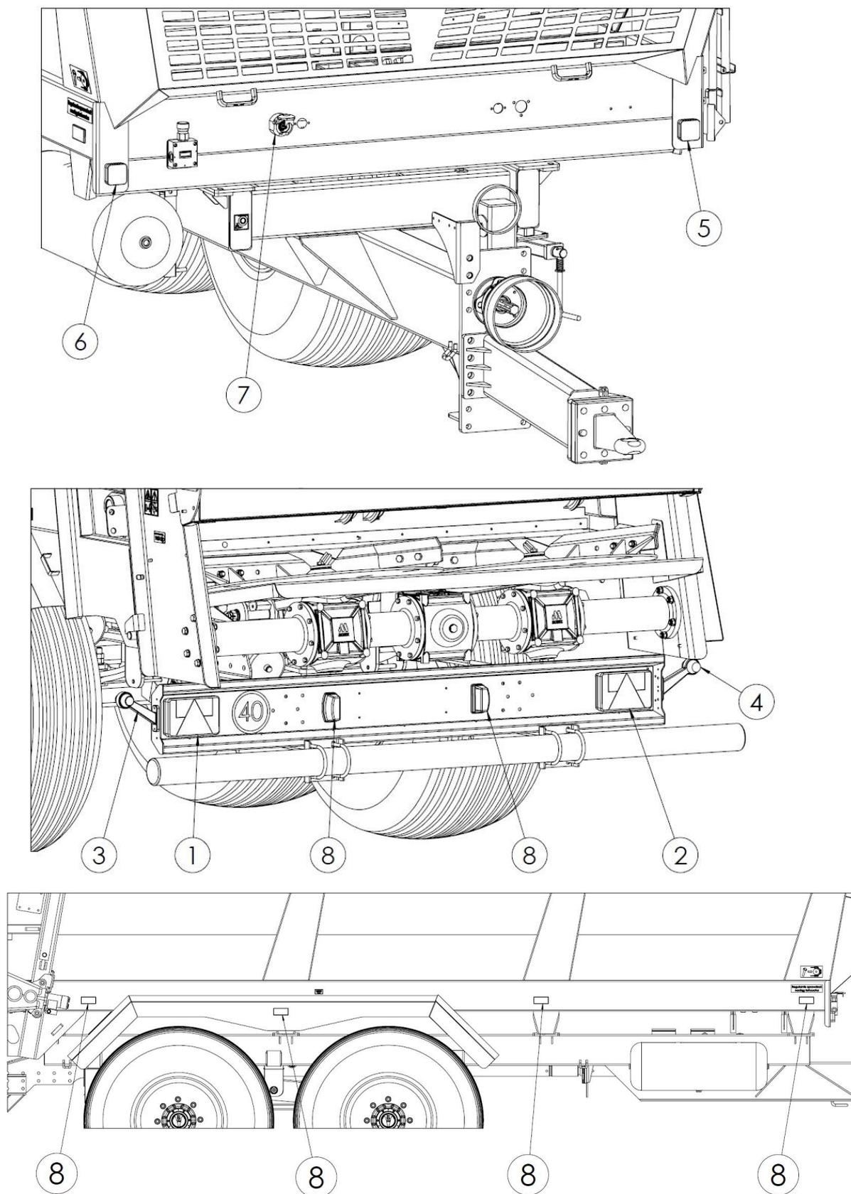
**Рисунок 15.** Расположение компонентов электрической системы
