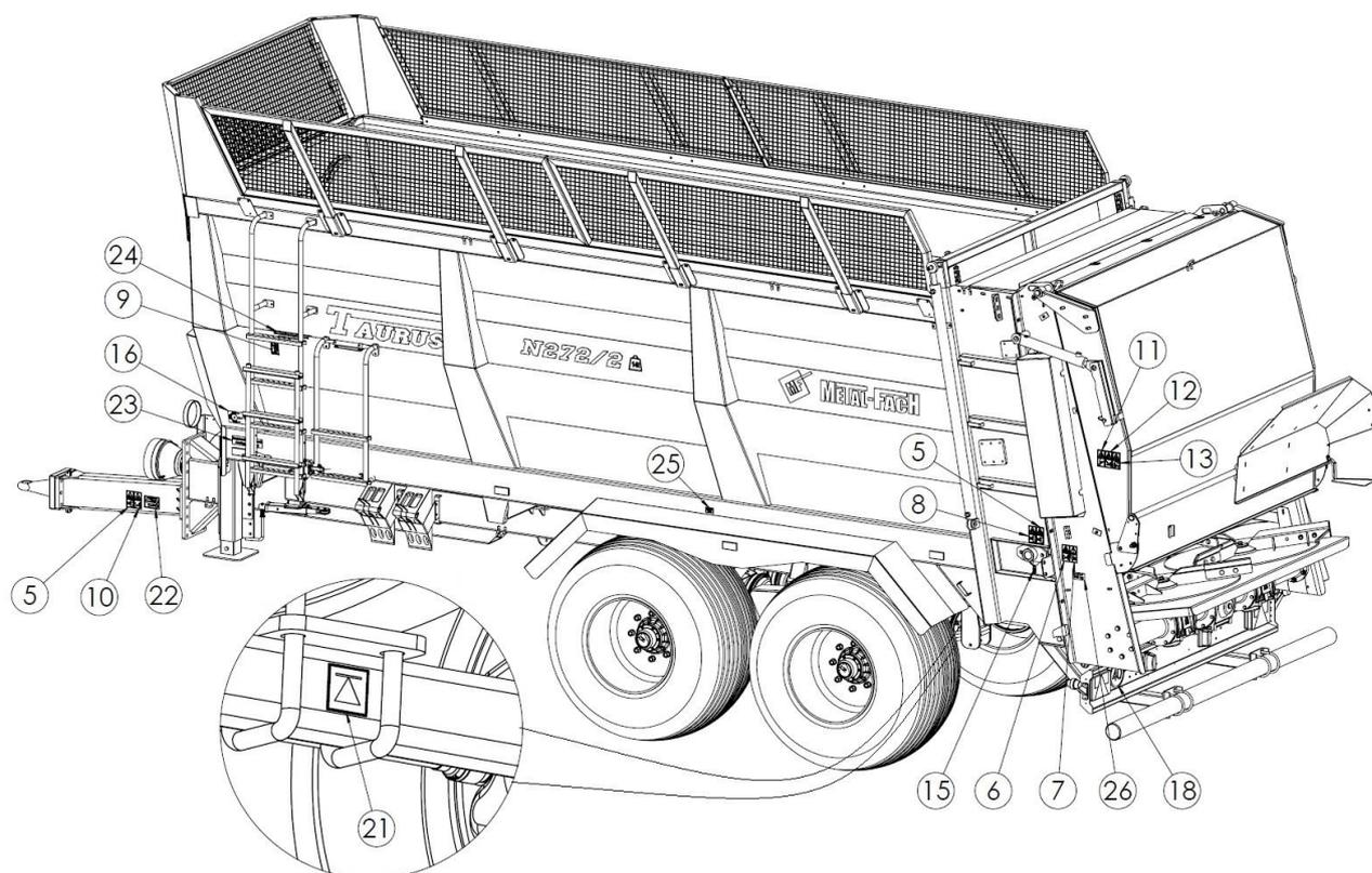
**Рисунок 7.** Расположение предупреждающих и информационных наклеек на горизонтальном адаптере.
