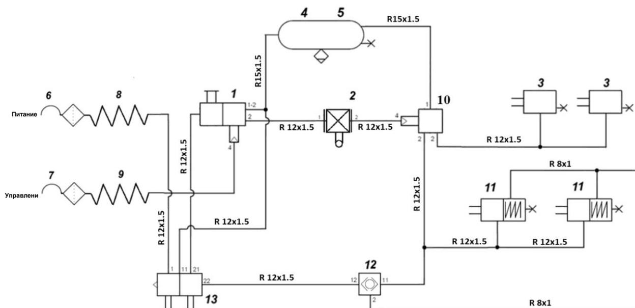
**Рисунок 12.** Двухпроводная пневматическая тормозная система с ALB
