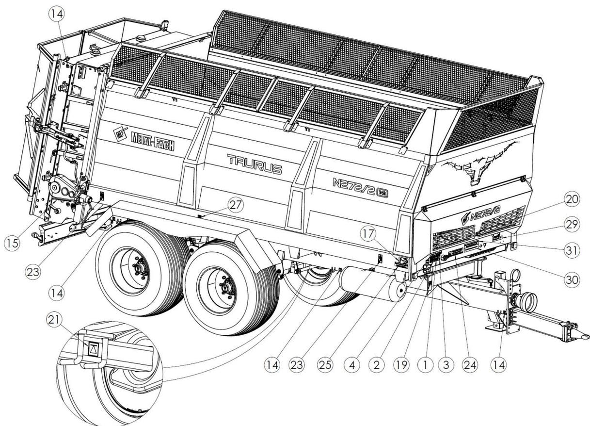
**Рисунок 5.** Расположение предупреждающих и информационных наклеек на вертикальном адаптере (перед)
