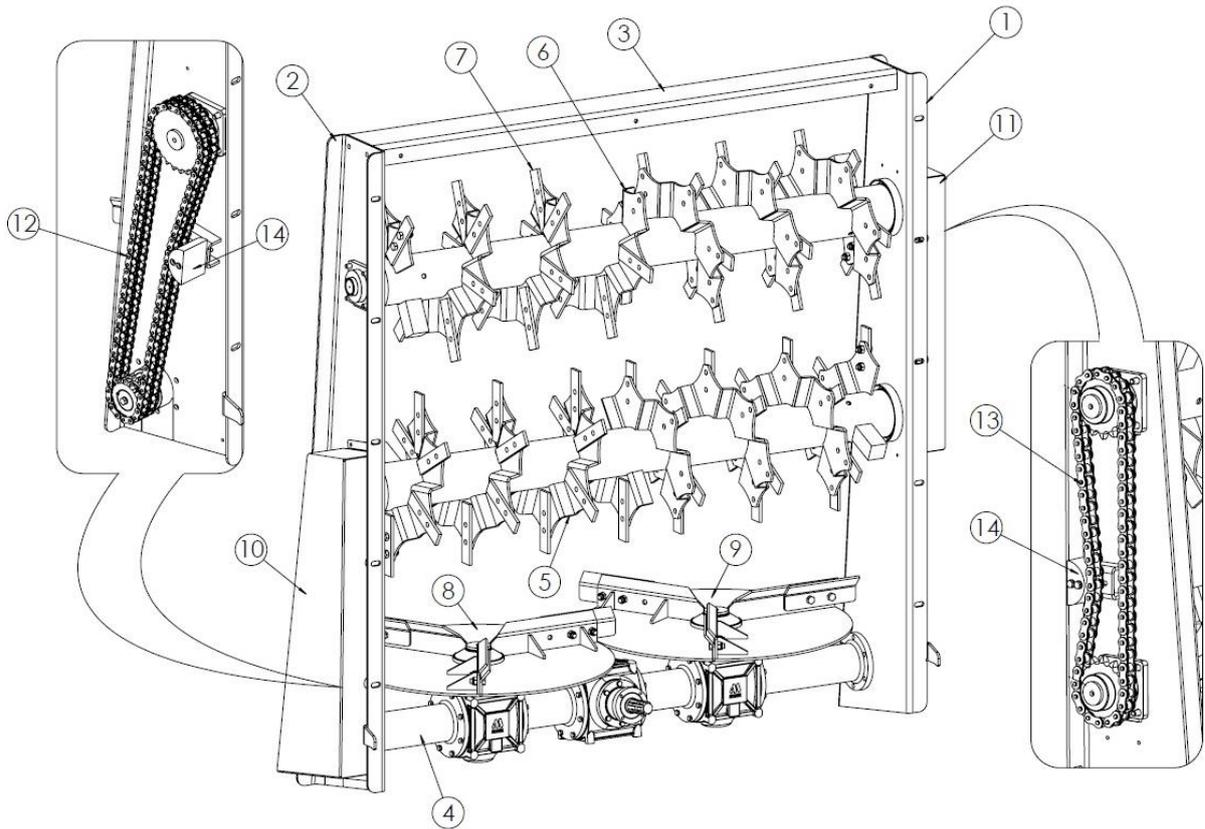
**Рисунок 11.** 2-роторный дисковый горизонтальный адаптер
