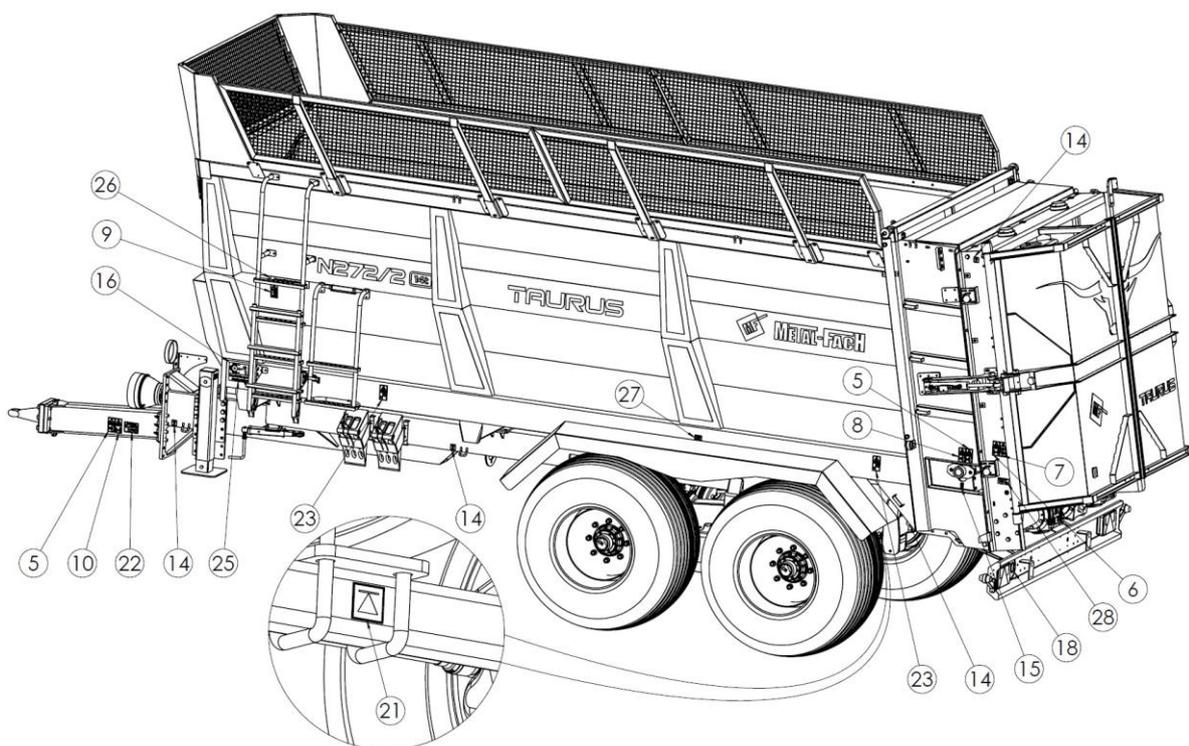
**Рисунок 6.** Расположение предупреждающих и информационных наклеек на вертикальном адаптере (тыльная часть)
