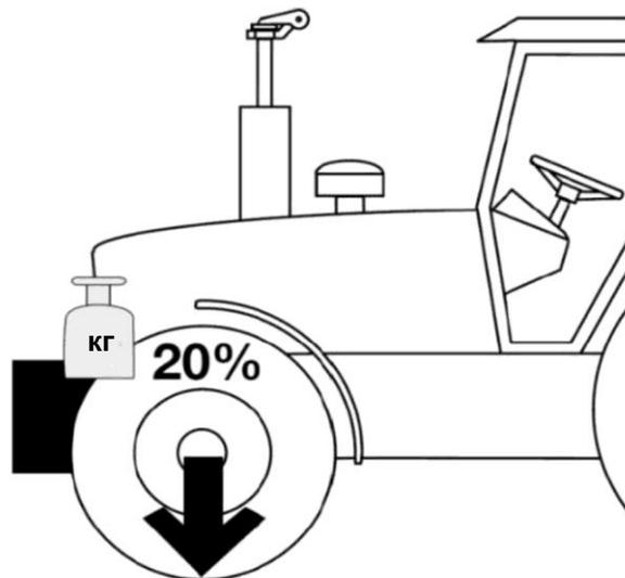
**Рисунок 4.** Минимальная нагрузка на переднюю ось трактора
