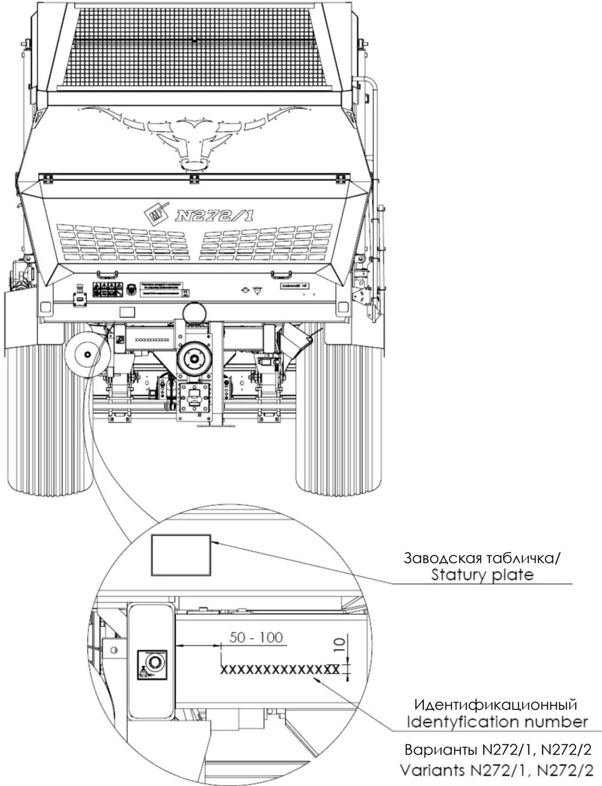
**Рисунок 3.** Расположение таблички и VIN номера
