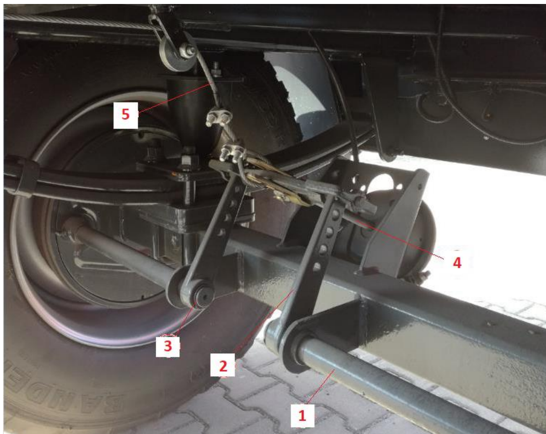
Рисунок 20. Элементы тормозной системы (1- вал тормозного кулака, 2 - рычаг (плечо) вала тормозного кулака, 3 - «гребень» регулировки плеча на валу тормозного кулака, 4 - трос (толкатель), соединяющий шток пневмопривода с плечом вала тормозного кулака, 5 - трос стояночного тормоза)
