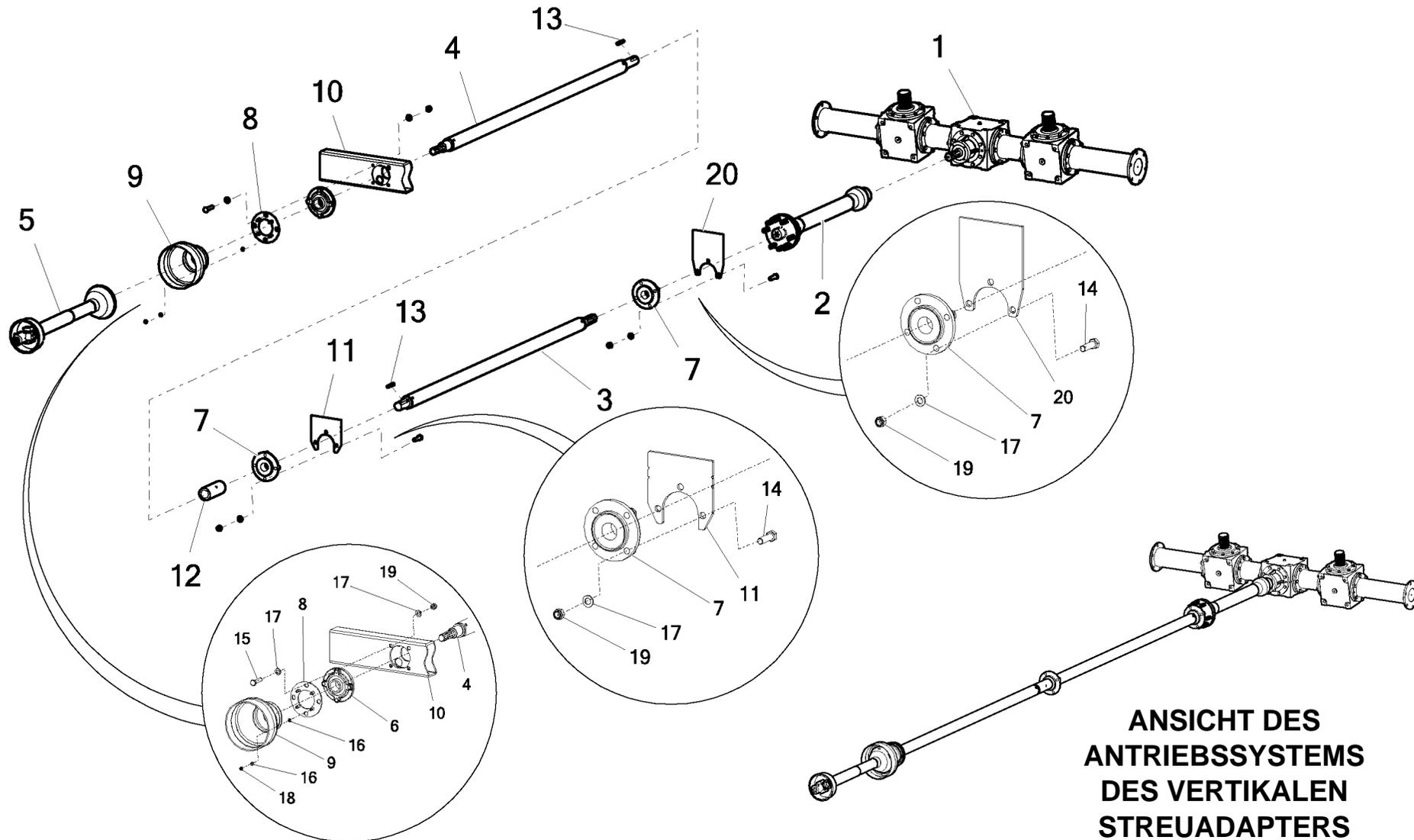
**ANSICHT DES ANTRIEBSSYSTEMS DES VERTIKALEN STREUADAPTERS**
