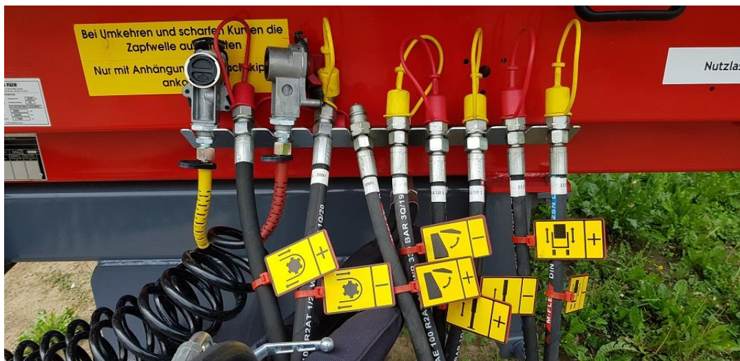
Rysunek 24. Oznaczenie złączy przewodów hydraulicznych piktogramami ułatwiającymi podłączenie przewodu do ciągnika
