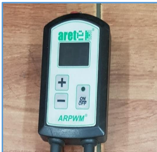
Rysunek 28. Panel sterujący regulacją prędkości przesuwu przenośnika podłogowego za pomocą przycisków „+/-”, – (wyposażenie opcjonalne).
