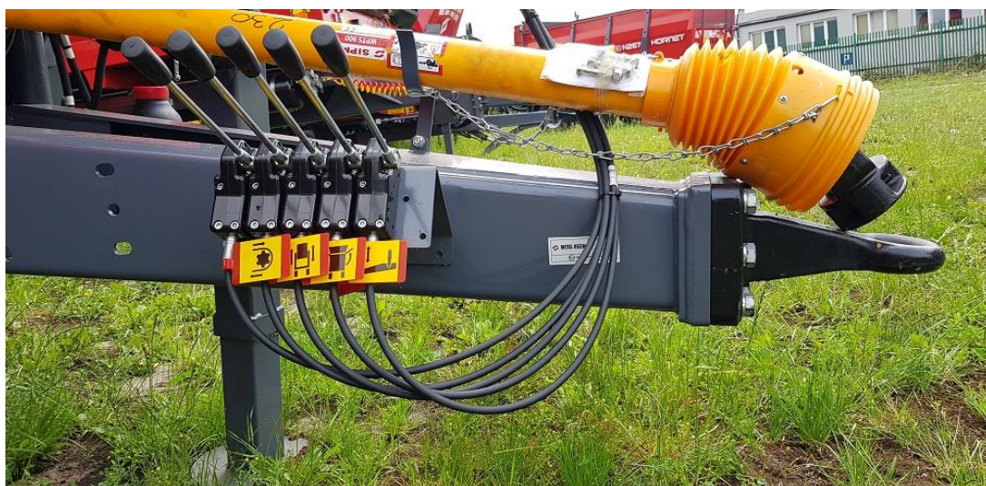
Rysunek 25. Oznaczenie piktogramami dźwigni sterujących rozdzielaczem (sterowanie rozdzielaczem występuje jako opcja)
