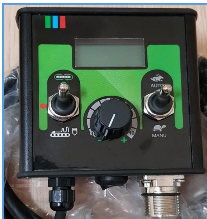
Rysunek 29. Panel sterujący regulacją prędkości przesuwu przenośnika podłogowego za pomocą potencjometru - gałki sterującej (wyposażenie opcjonalne).
