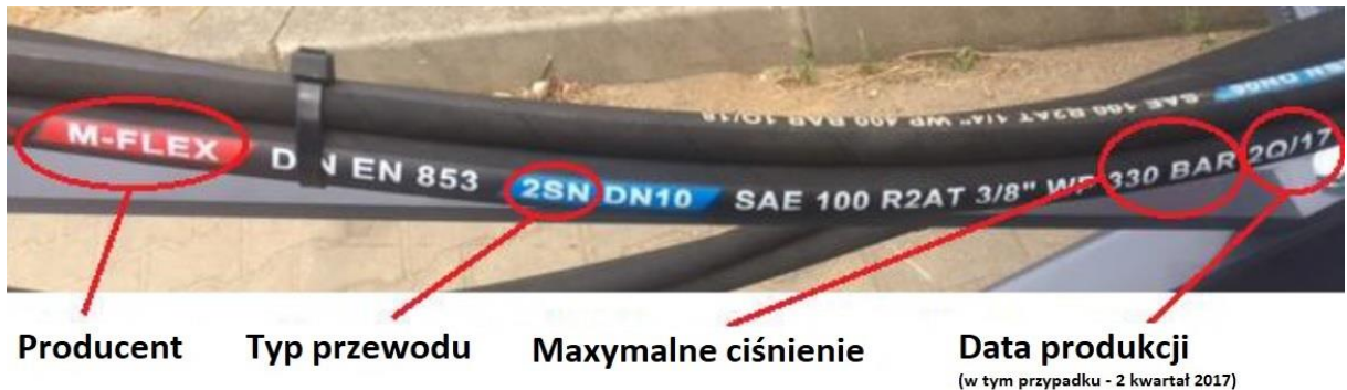
Rysunek 23. Oznaczenia przewodów hydraulicznych
