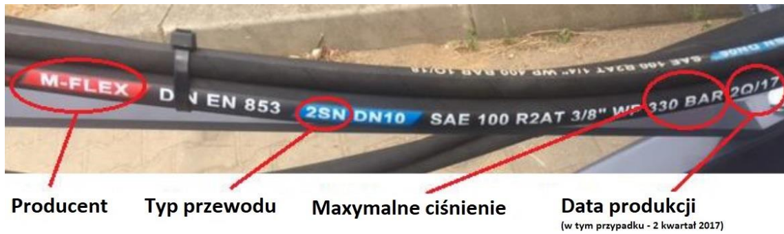
Rysunek 21. Oznaczenie przewodów hydraulicznych
