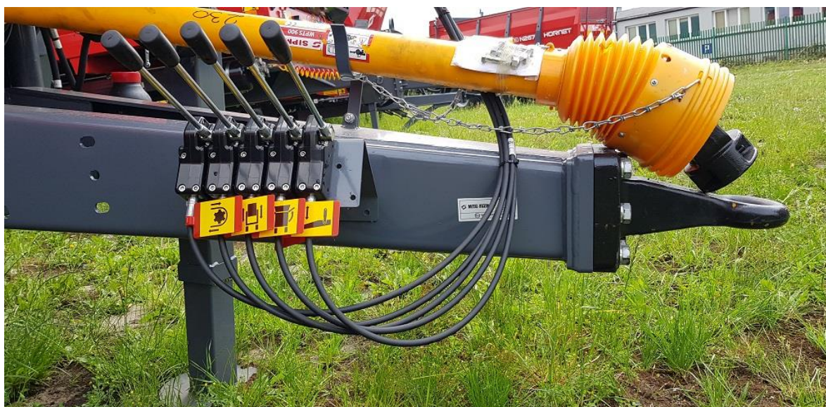
Rysunek 23. Oznaczenie piktoqramami dźwigni sterujących rozdzielaczem (sterowanie rozdzielaczem występuje jako opcja)
