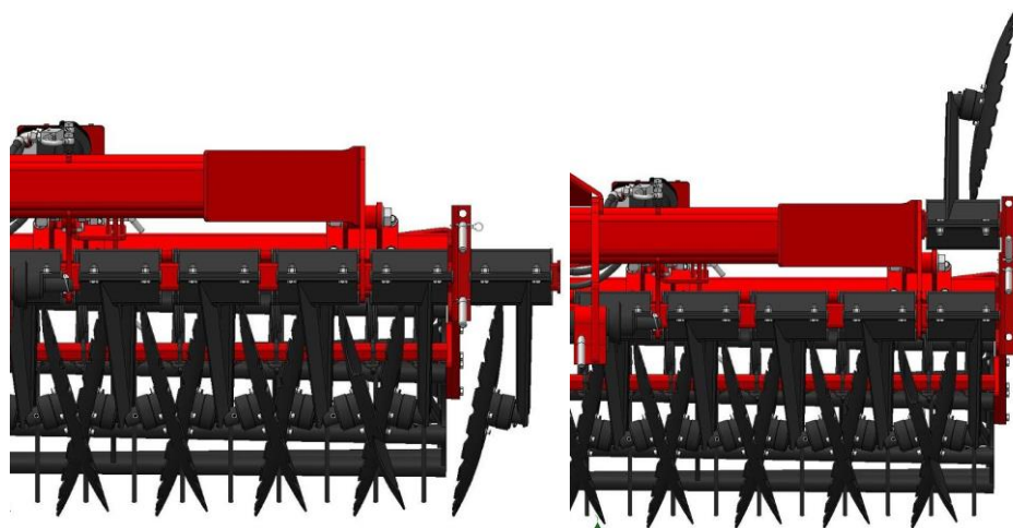
Figura 3. Posición de trabajo y posición de transporte (secciones laterales plegadas)
