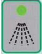
**Aplicador** - Encendido y apagado del aplicador. Pulsando el botón se activa el aplicador. Pulsando de nuevo se desactiva. La luz verde indica que el aplicador está en funcionamiento.
