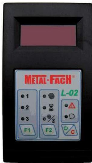
Rysunek 39. Compteur de tours d'enrubannage L-02
