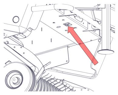
Figure 26. Drain cap
