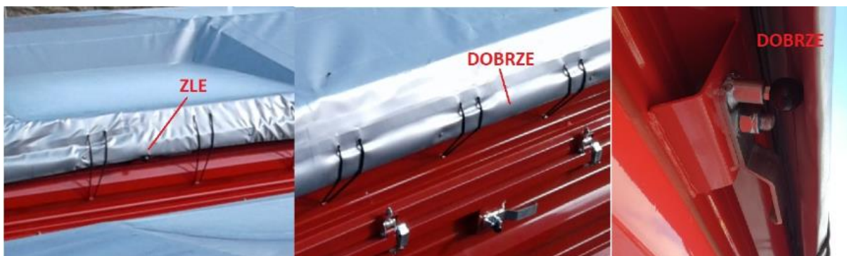
Rysunek 4. Prawidłowy naciąg plandeki
