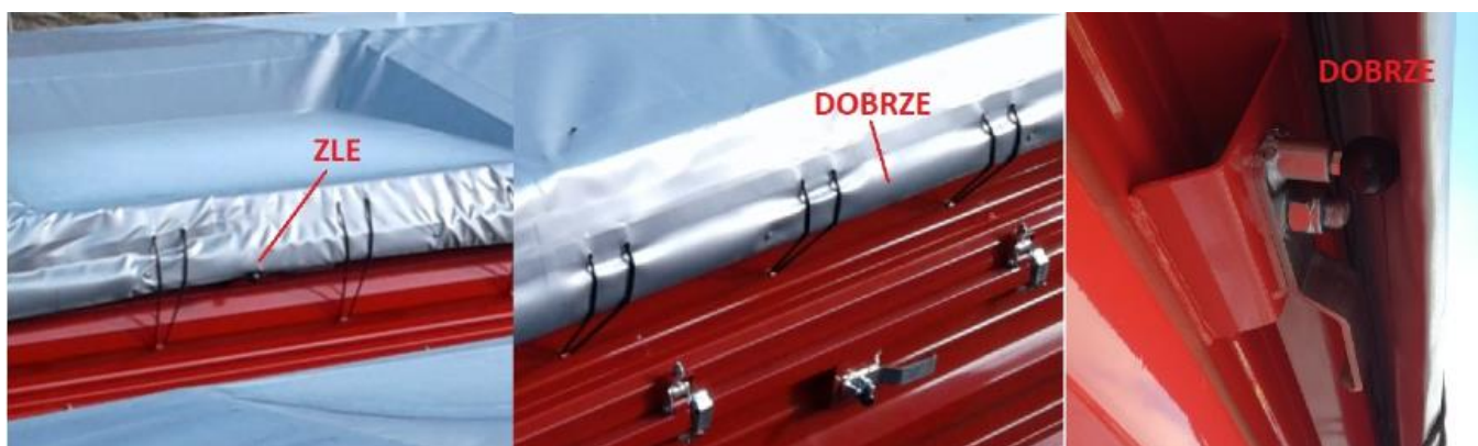
Rysunek 4. Prawidłowy naciąg plandeki
