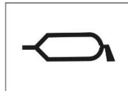
Rysunek 25. Oznaczenie miejsc smarowania prasy
