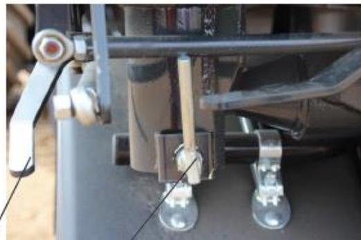
**Рисунок 14.** Замки бортов грузового кузова.
