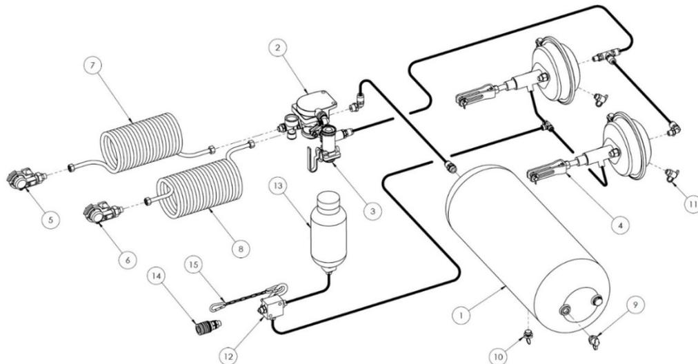
Пневмогидравлическая тормозная система
