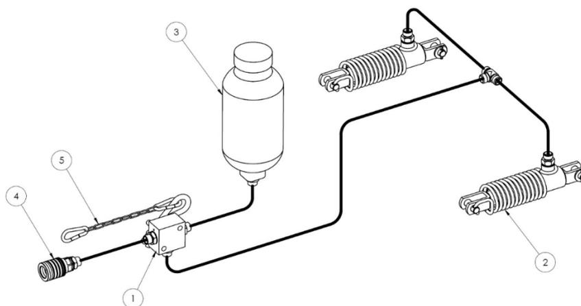
Однопроводная гидравлическая тормозная система
