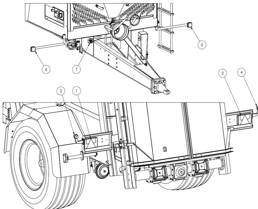
Расположение элементов электрической системы: 1 - задний левый комбинированный фонарь, 2 - задний правый комбинированный фонарь, 3 - левый габаритный фонарь, 4 - правый габаритный фонарь, 5 - передний левый габаритный фонарь, 6 - передний правый габаритный фонарь, 7 - соединительная розетка
