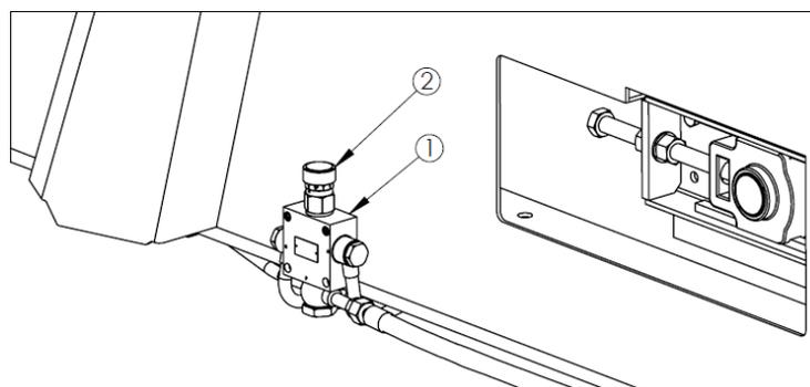
Регулировка скорости перемещения напольного конвейера
