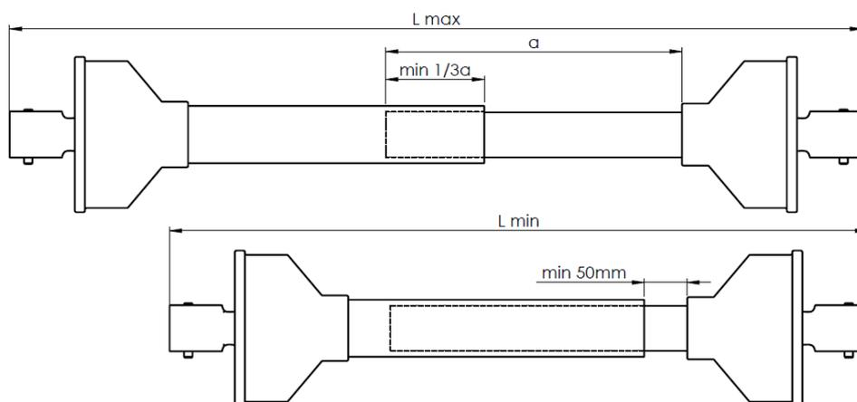
Регулировка длины вала при присоединении навозоразбрасывателя к трактору
