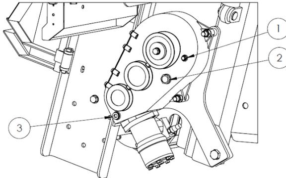
Точки контроля уровня масла редуктора напольного конвейера.
