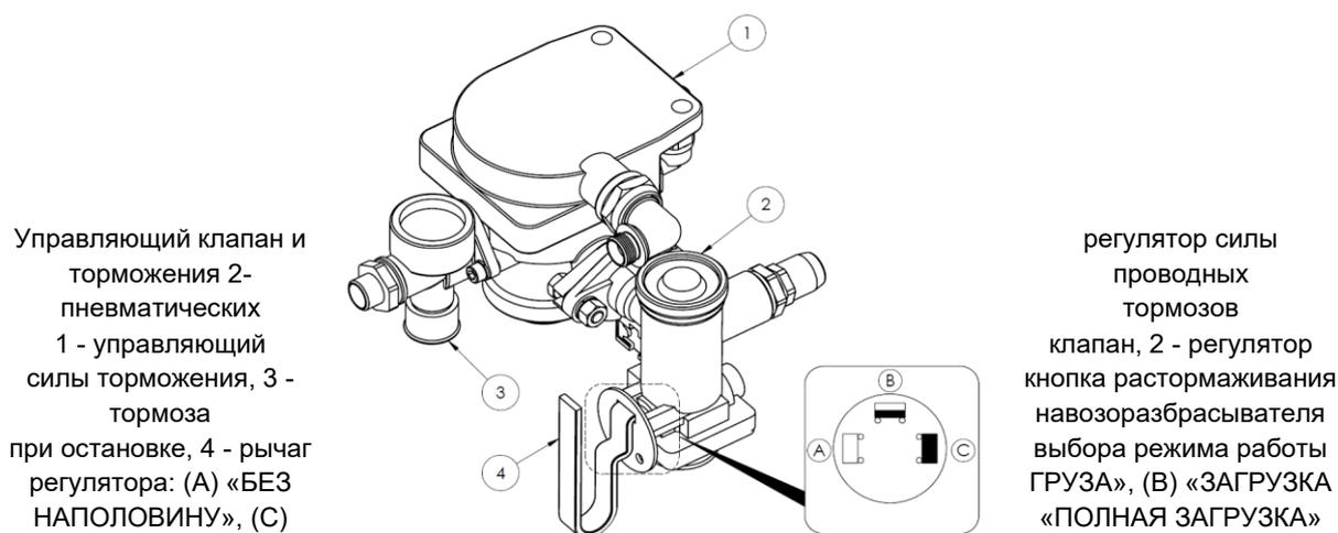
Управляющий клапан и торможения 2- пневматических 1 - управляющий силы торможения, 3 - тормоза при остановке, 4 - рычаг регулятора: (А) «БЕЗ НАПОЛОВИНУ», (С)
