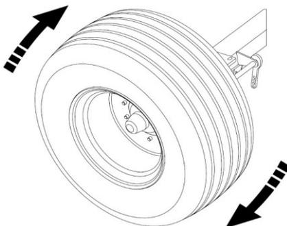
Проверка зазоров подшипников колес
