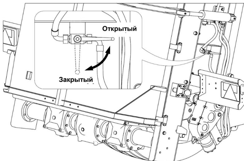
Гидравлический клапан для блокировки крышки адаптера
