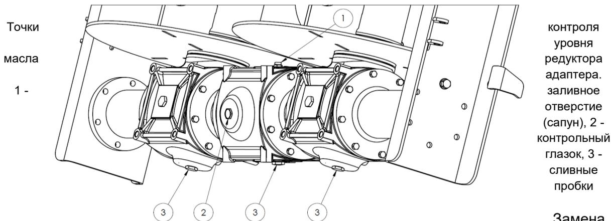
Замена масла должна производиться при рабочей температуре непосредственно после окончания работы, когда масло еще горячее. Выполните замену, поместив навозоразбрасыватель на твердую горизонтальную поверхность. При замене используйте соответствующую защитную одежду, инструменты и емкости. Отработанное масло следует хранить в надлежащем образом маркированных емкостях и утилизировать в соответствии с действующими правилами.
