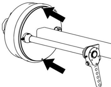
Проверка износа тормозных накладок
