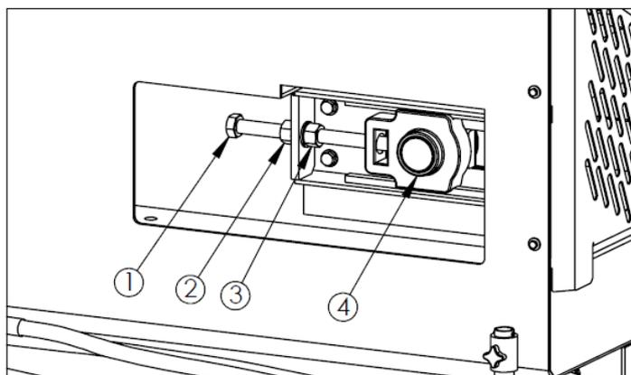
Натяжение цепей напольного конвейера
