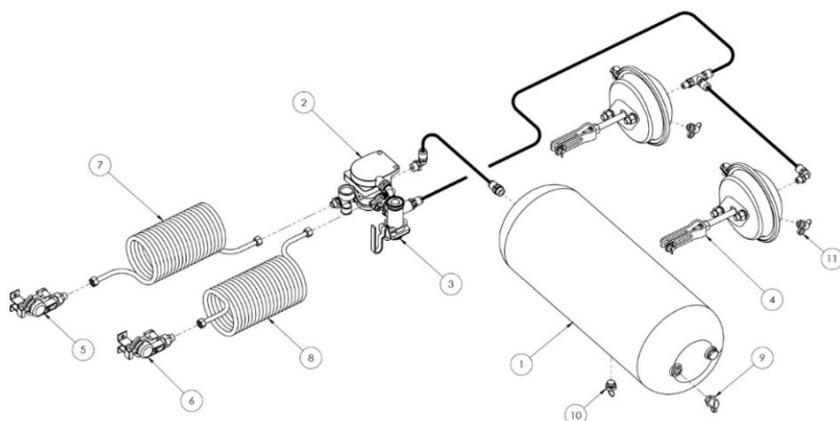
**Двухпроводная пневматическая тормозная система**
