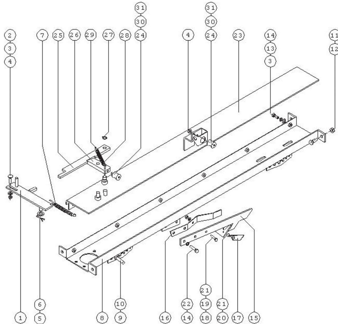
Корпус механизма обвязывания шпагатом
